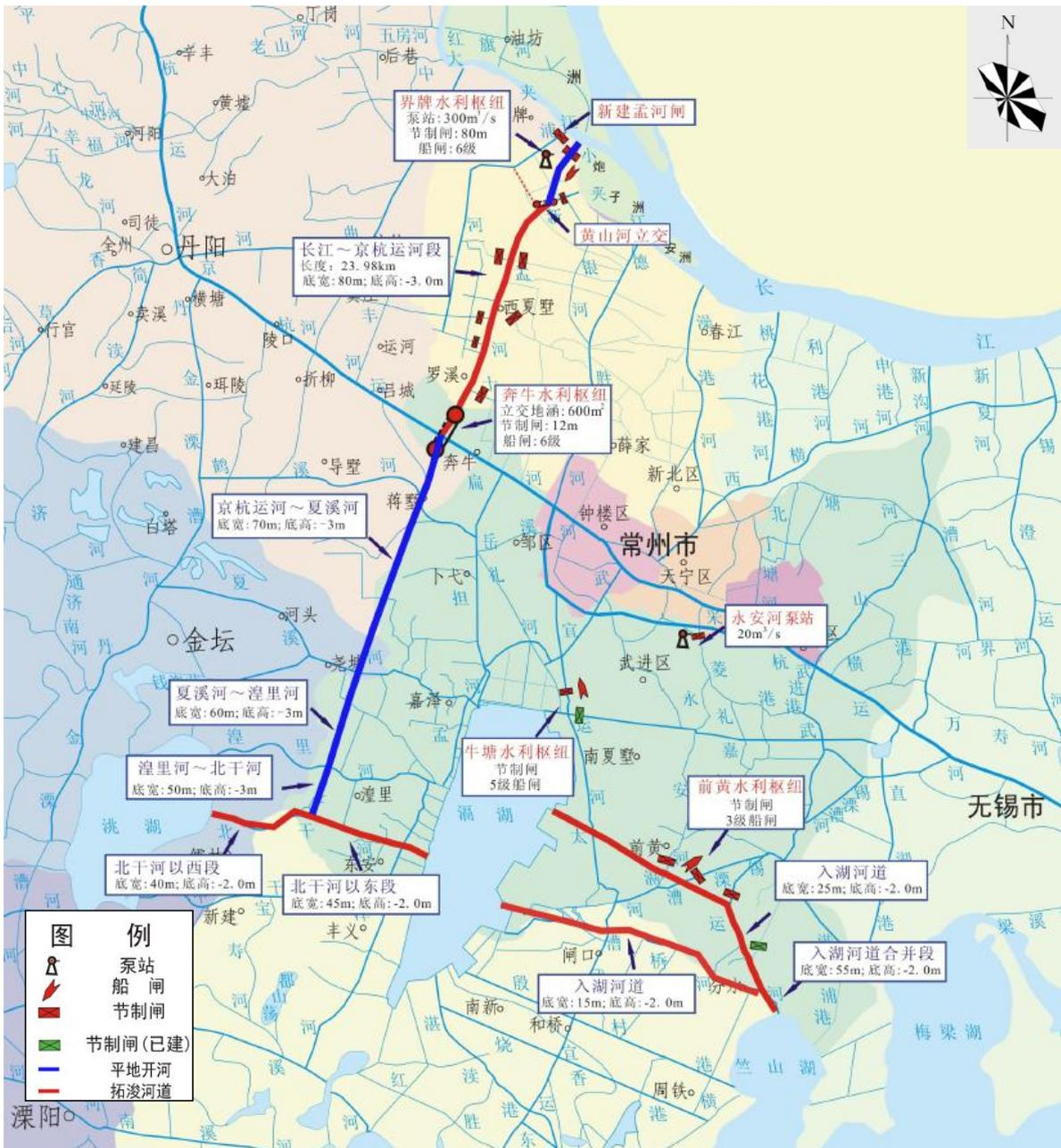
图 2.1-1 新孟河延伸拓浚工程竣工总平面布置图
