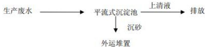
图 5.1-1 生产废水处理工艺流程
