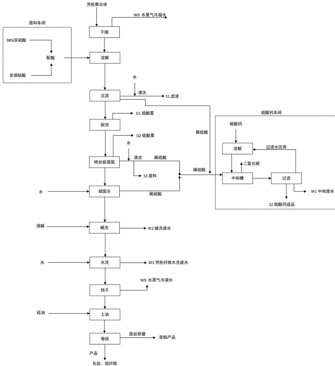
图 3-7 生产工艺流程及产污环节图
