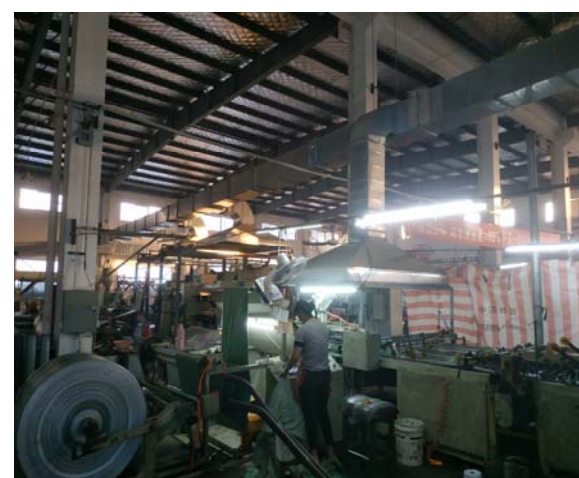
热切割废气收集系统
