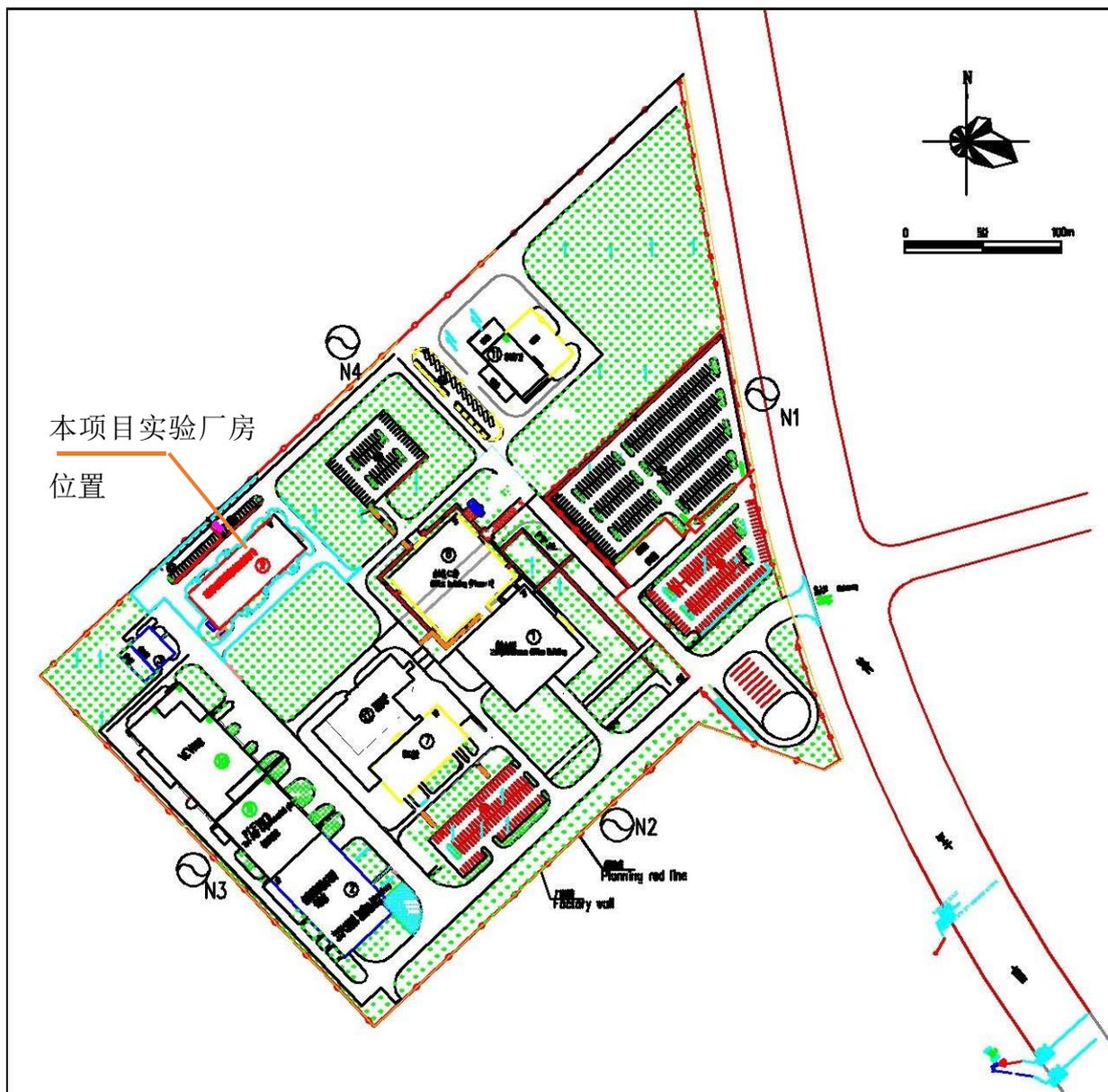
图 3-3 建设项目平面布置及噪声监测点位分布图
