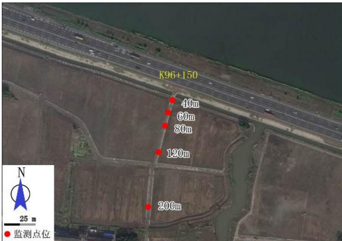
图 6-9 K96+150（运营桩号）衰减断面监测点位示意图
