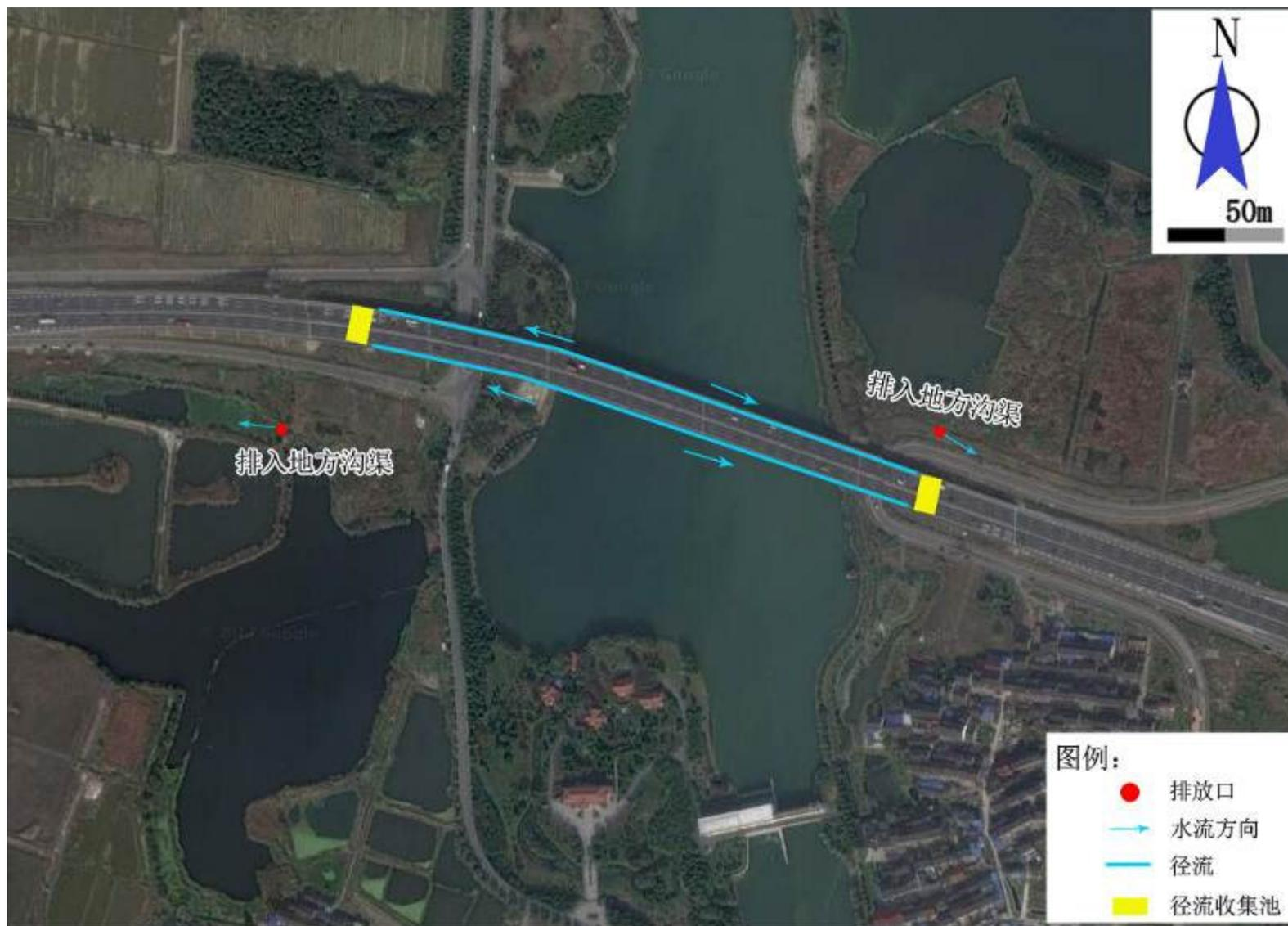
图 8-7 西塘河大桥桥面径流系统卫星影像
