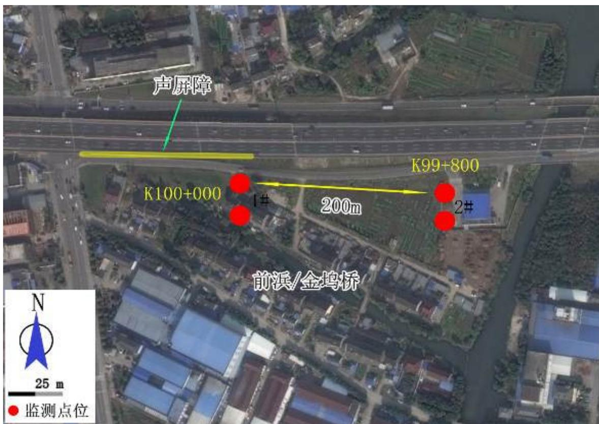
图 6-12 前浜/金坞桥声屏障效果监测点位示意图
