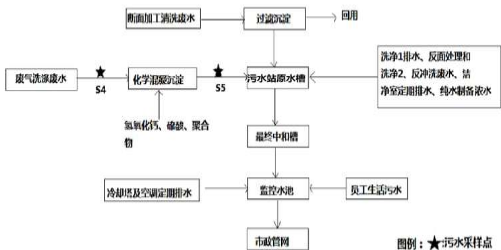
图 4-1 污水处理工艺流程图
