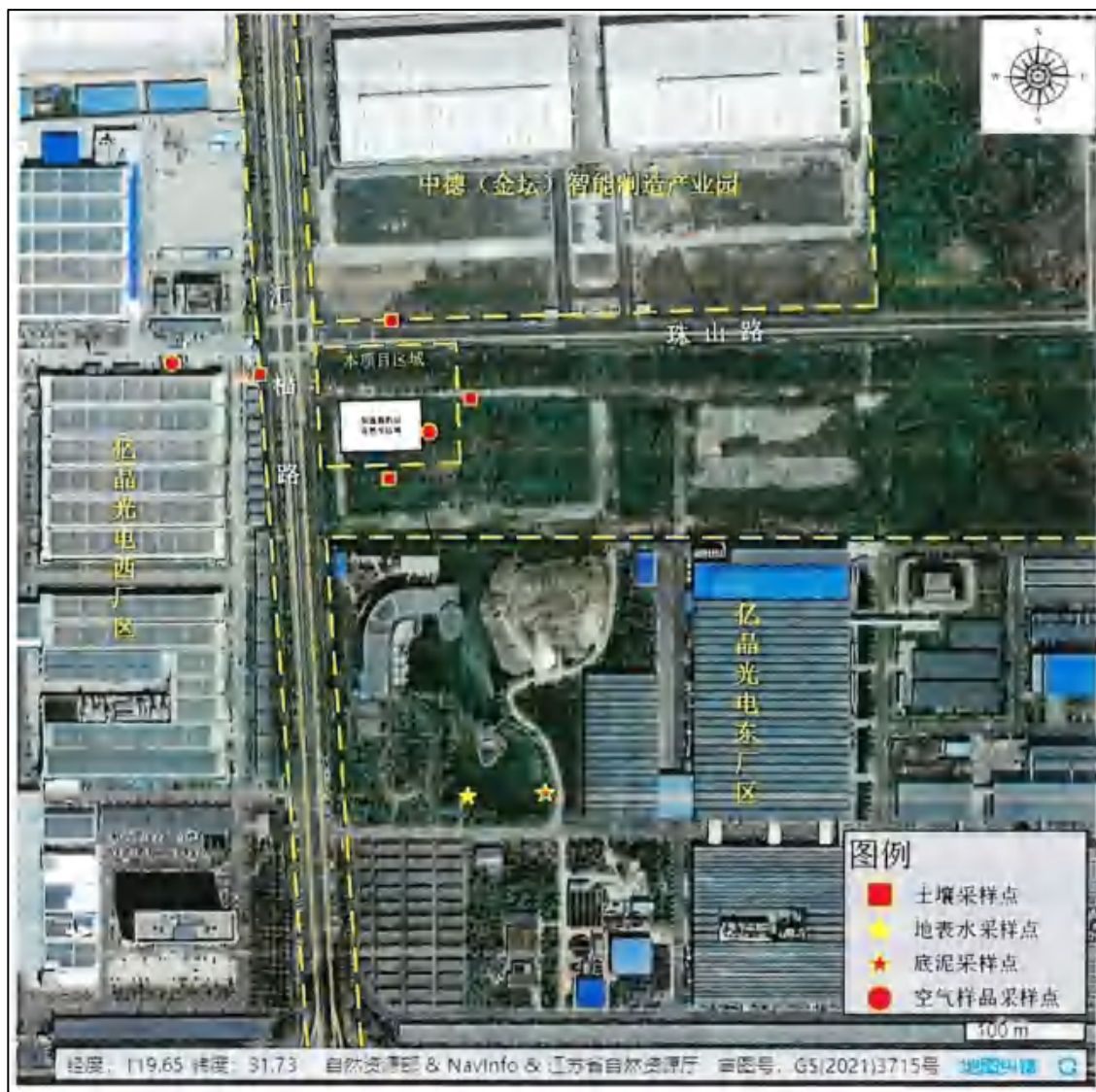
图2.4-2 环境空气、土壤、底泥和地表水现场采样点位布设示意图
