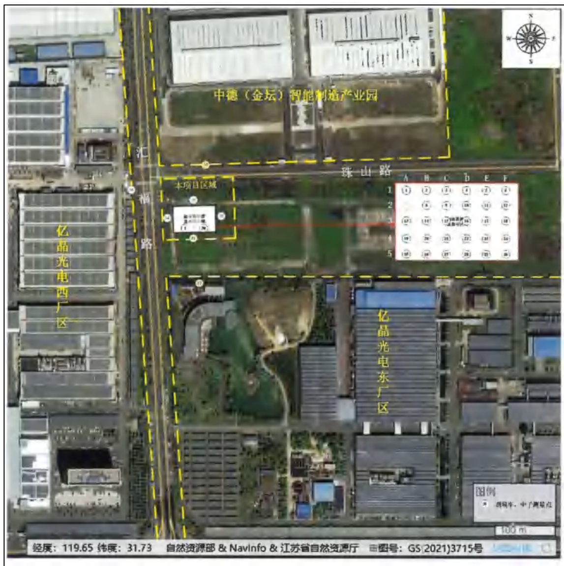
图2.4-1 环境 \gamma 空气吸收剂量率、中子周围剂量当量率检测点位布设示意图
