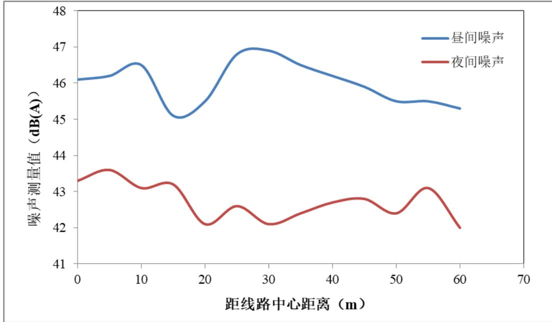
图 6.2-2 500kV 单回架设线路噪声类比监测值趋势图
