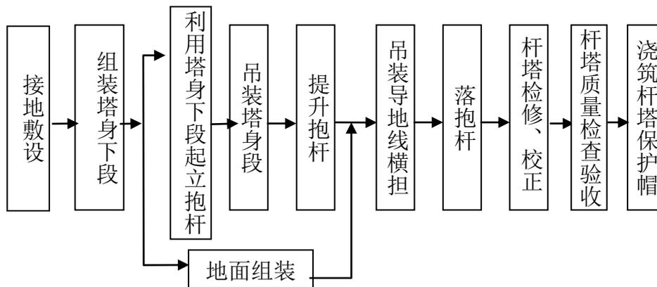
图 3.1-19 杆塔组立施工流程图
