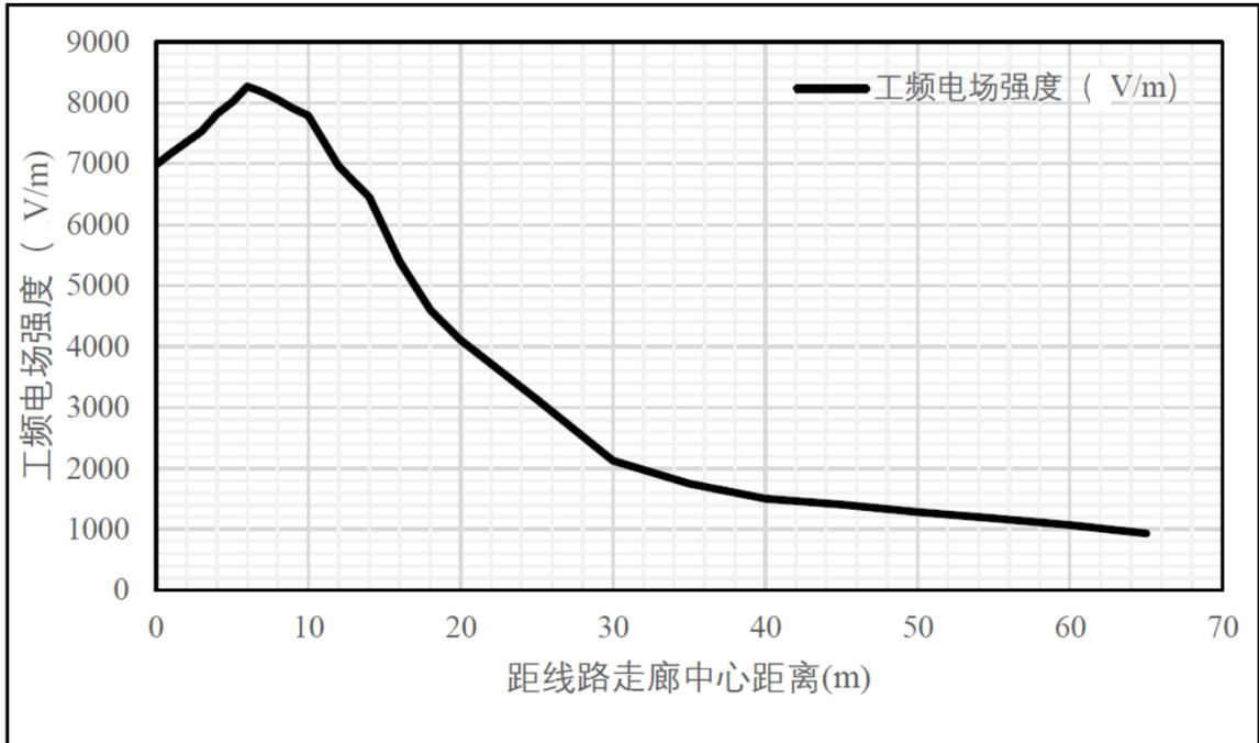
图 6.1-9 (1) 交叉跨越线路衰减断面工频电场强度变化趋势
