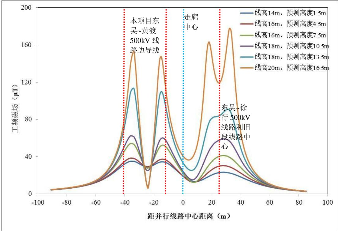
图 6.1-14 情形 1 不同计算高度工频磁感应强度预测结果
