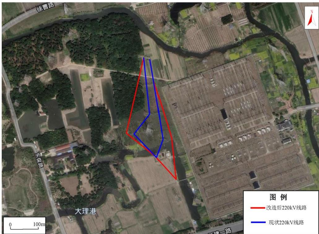
**图 3.1-10 本段线路路径示意图**
