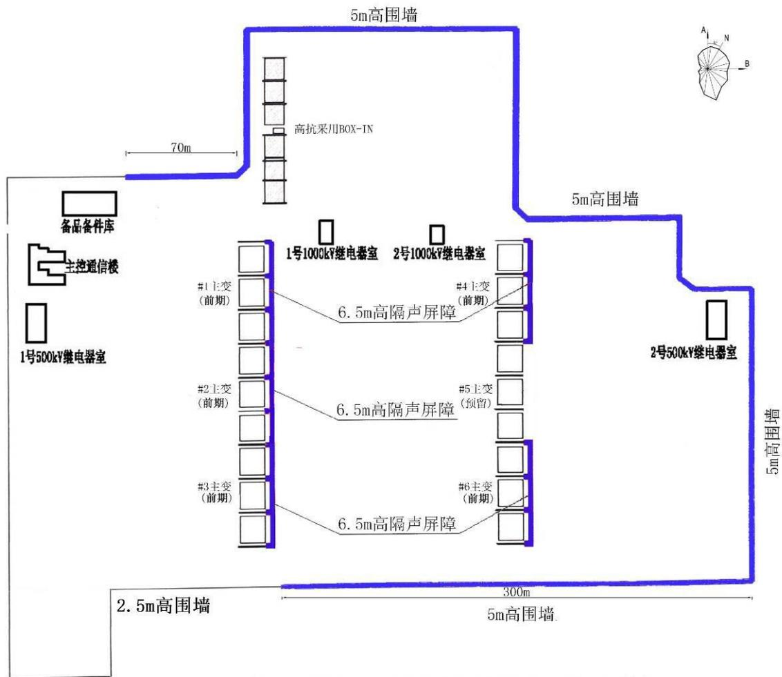
图 3.1-11 东吴变电站降噪措施示意图
