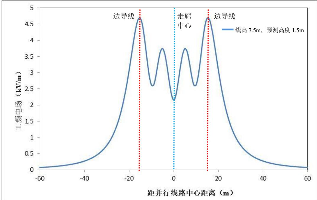
图 6.1-32 情形 9 工频电场强度预测结果
