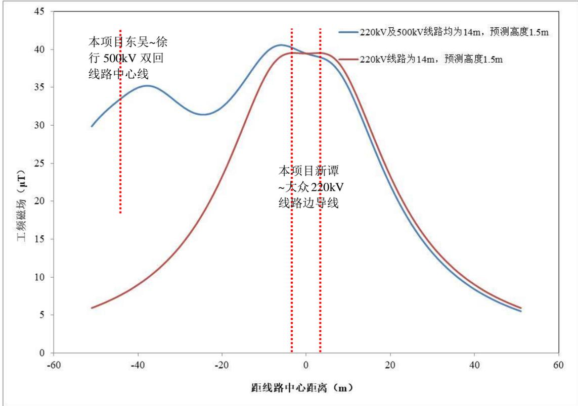
图 6.1-31 情形 8 工频磁感应强度预测结果
