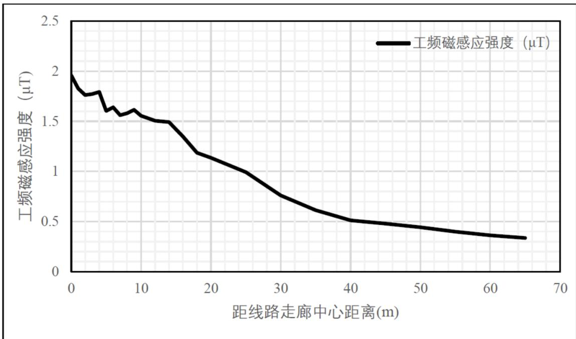
图 6.1-9 (2) 交叉跨越线路衰减断面工频磁感应强度变化趋势
