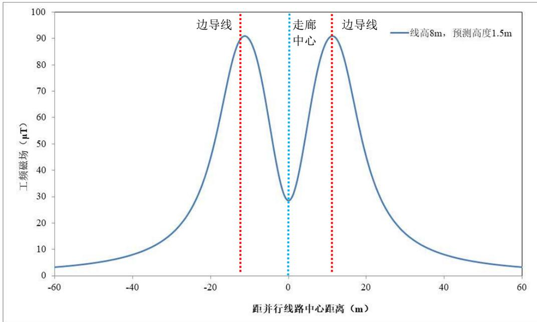
图 6.1-33 情形 9 工频磁感应强度预测结果
