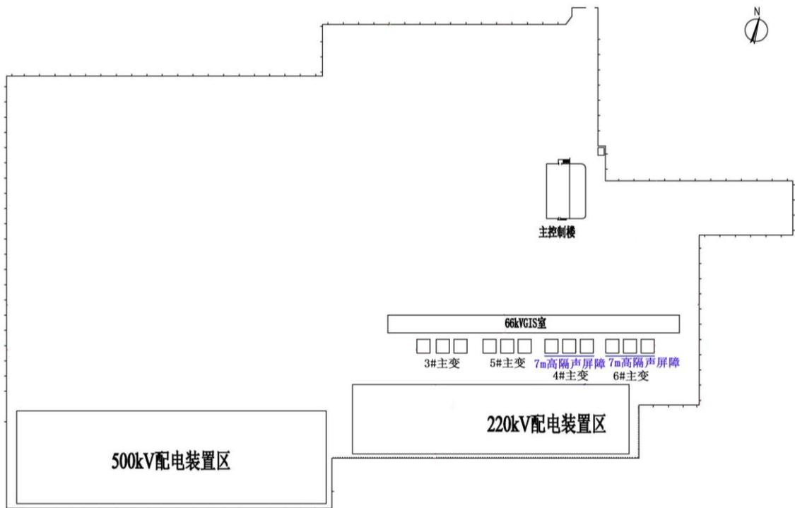
图 3.1-14 黄渡变电站降噪措施示意图
