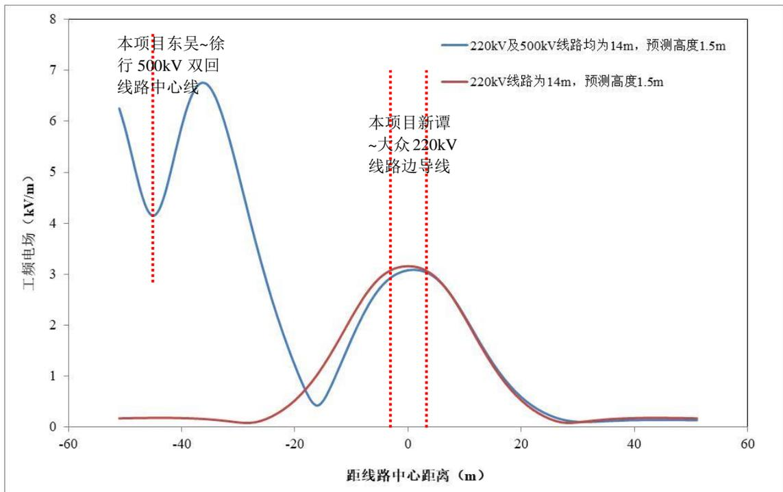
图 6.1-30 情形 8 工频电场强度预测结果
