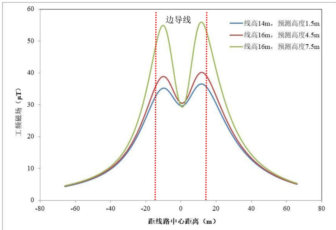
图 6.1-16 情形 2 不同计算高度工频磁感应强度预测结果
