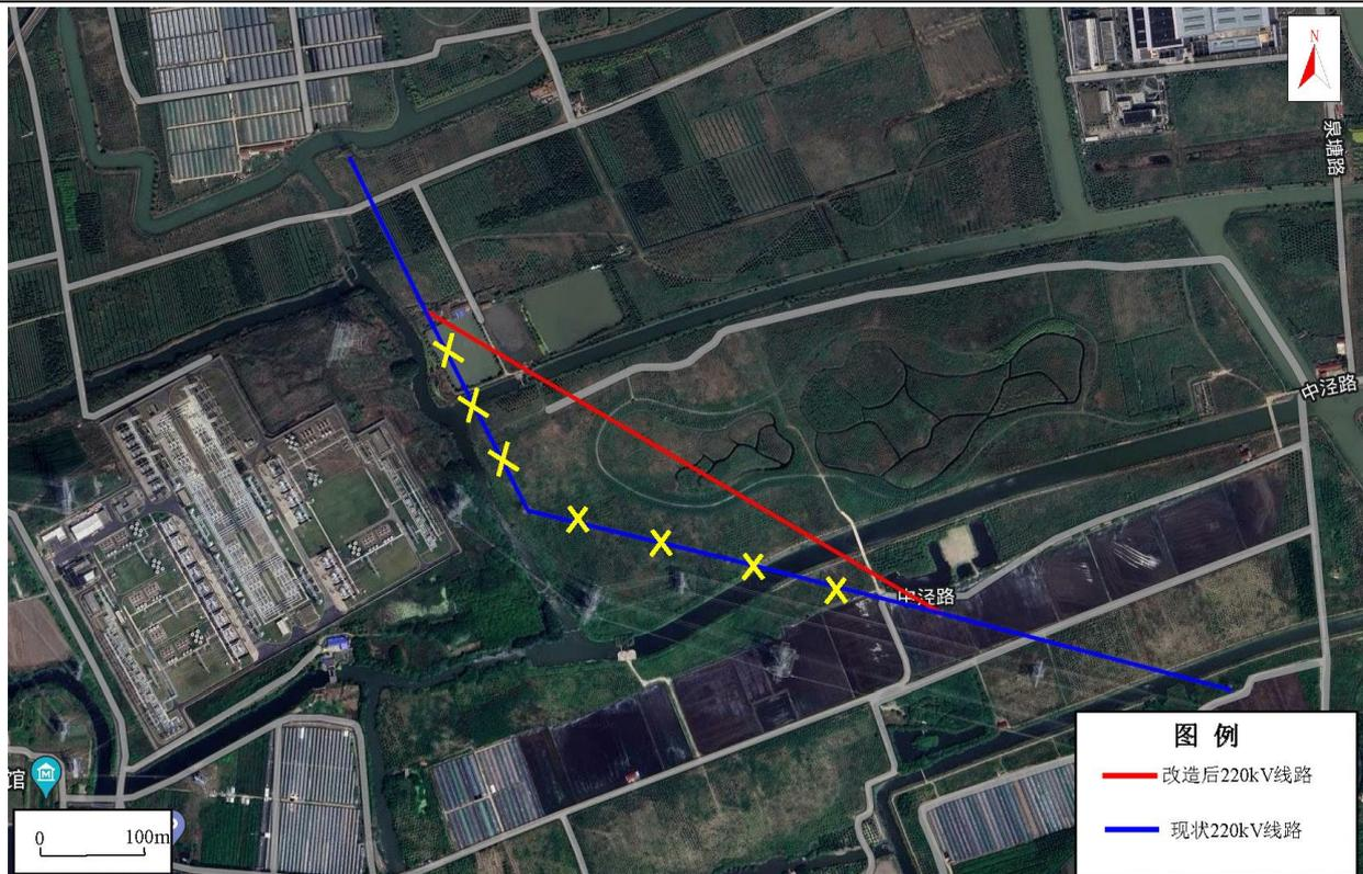
图 3.1-9 本段线路路径示意图
