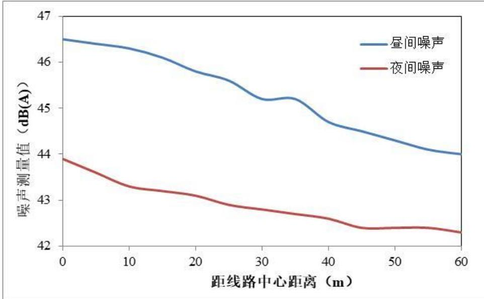
图 6.2-4 500kV/220kV 混压同塔四回线路噪声类比监测值趋势图
