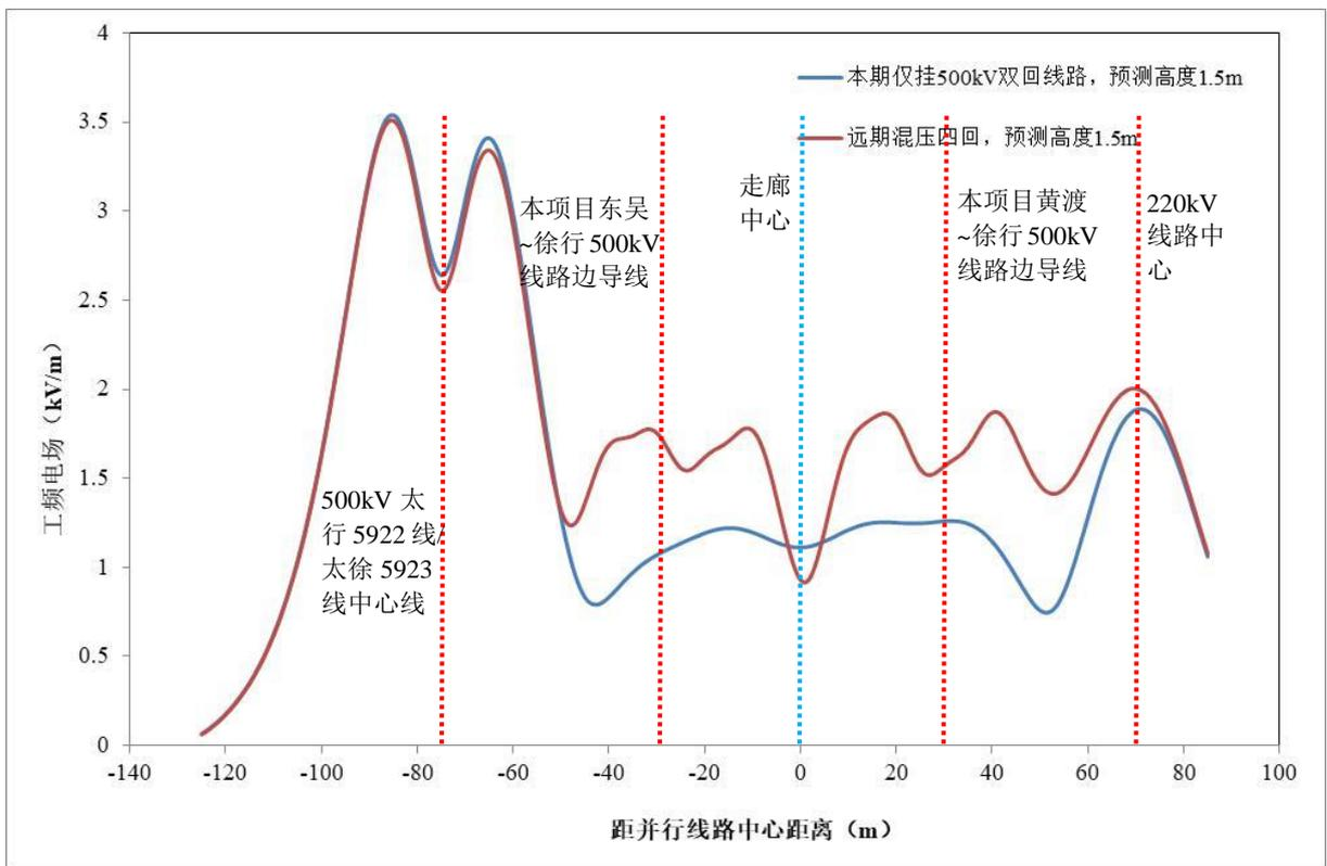
图 6.1-28 情形 7 工频电场强度预测结果
