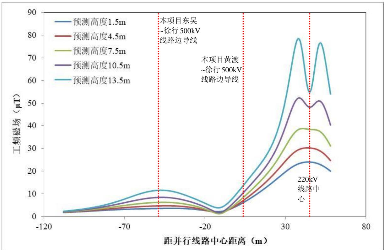
图 6.1-26 情形 6 (本期仅挂 500kV 双回线路) 不同计算高度工频磁感应强度预测结果
