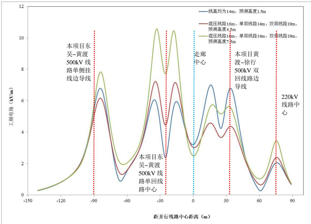
图 6.1-18 情形 3 不同计算高度工频电场强度预测结果
