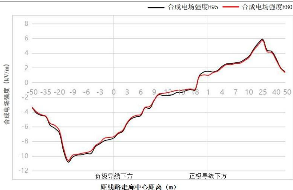
图 6.1-2 ±800kV 锡泰线类比监测合成电场分布图
