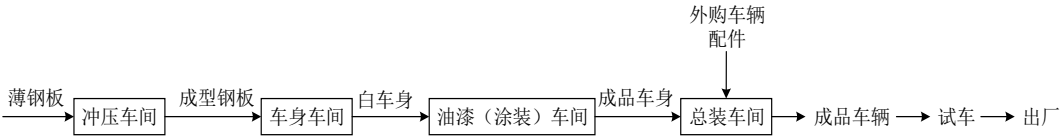
图 2.2-1 整车总体生产工艺流程
