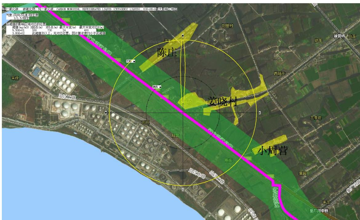
图 6.8-3 最不利气象条件下下风向 (N) CO 大气毒性终点距离图 (mg/m<sup>3</sup>)
