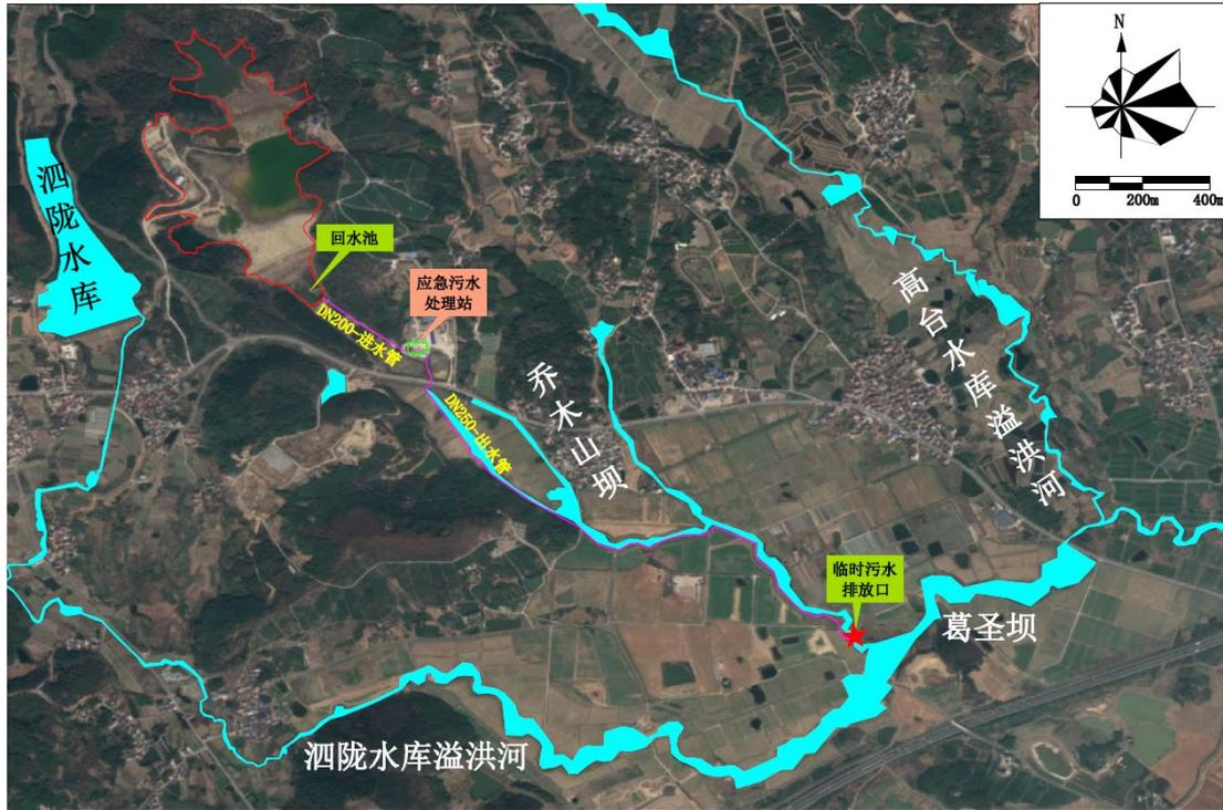
图 7.1.1-2 应急污水处理站管线布置图
