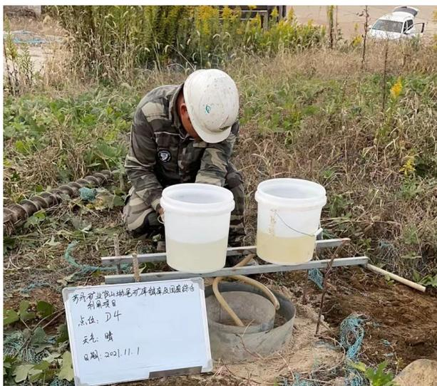
图 5.3.7-2 双环渗水试验现场照片
