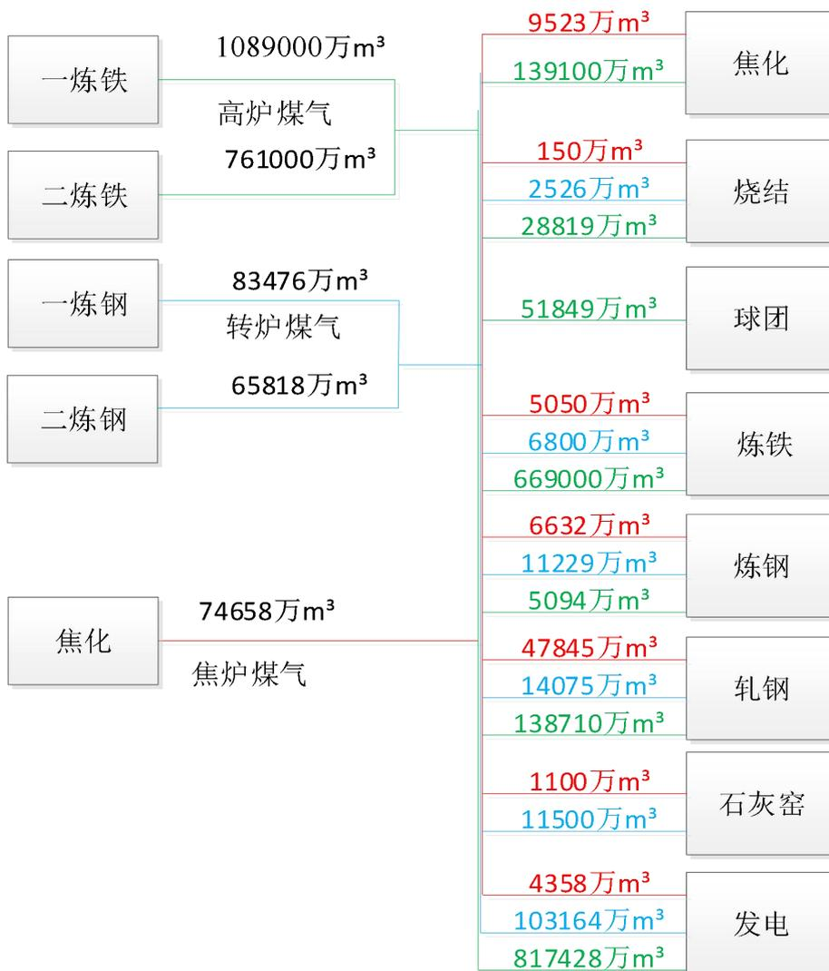
图 3.1.6-1 现有项目煤气平衡图 (单位: 万 m³/a)
