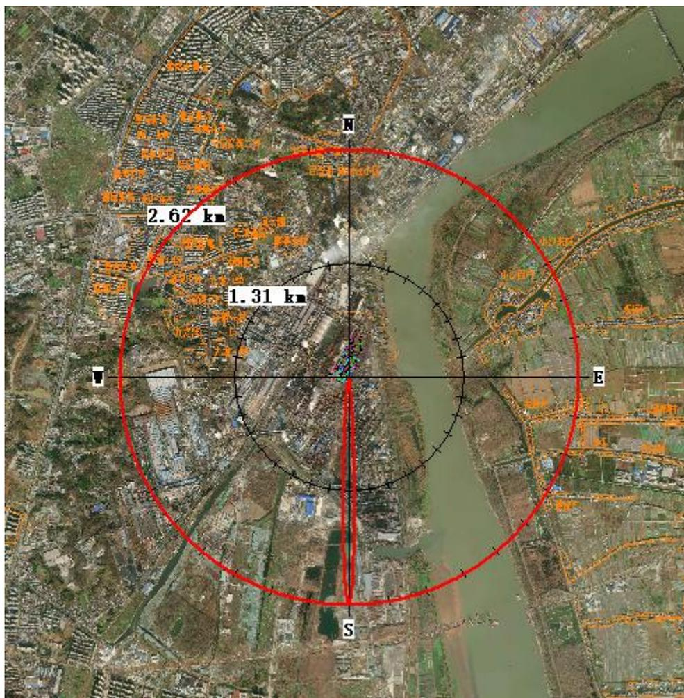
图 6.2.5-2 最不利条件下氨水扩散示意图
