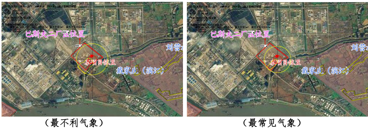
图 6.3.3-1 氨泄漏超过阈值的最大轮廓线图
