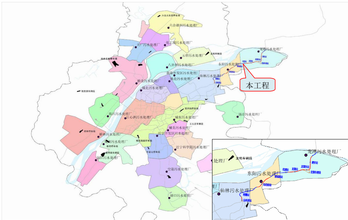
图 4.4-7 工程与南京市政污水管网位置关系示意图
