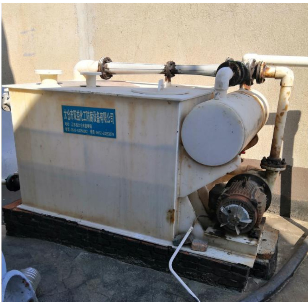
图 7.1-2水喷射真空废气吸收器示意图
