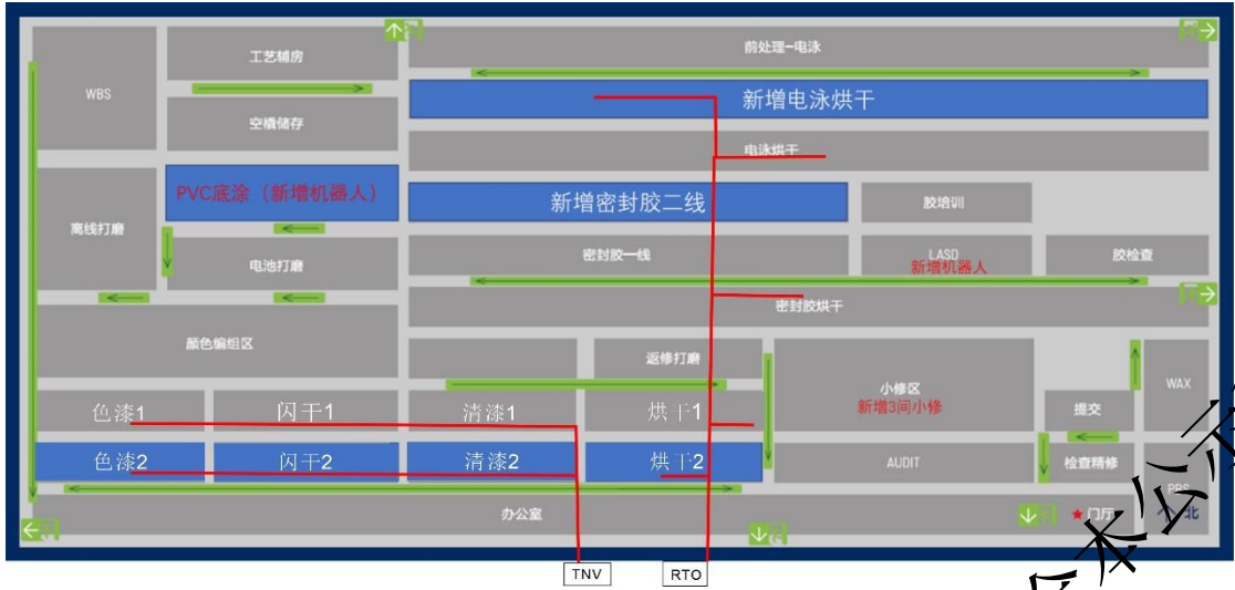
图 7.1-2 涂装车间废气收集、处理系统示意图
