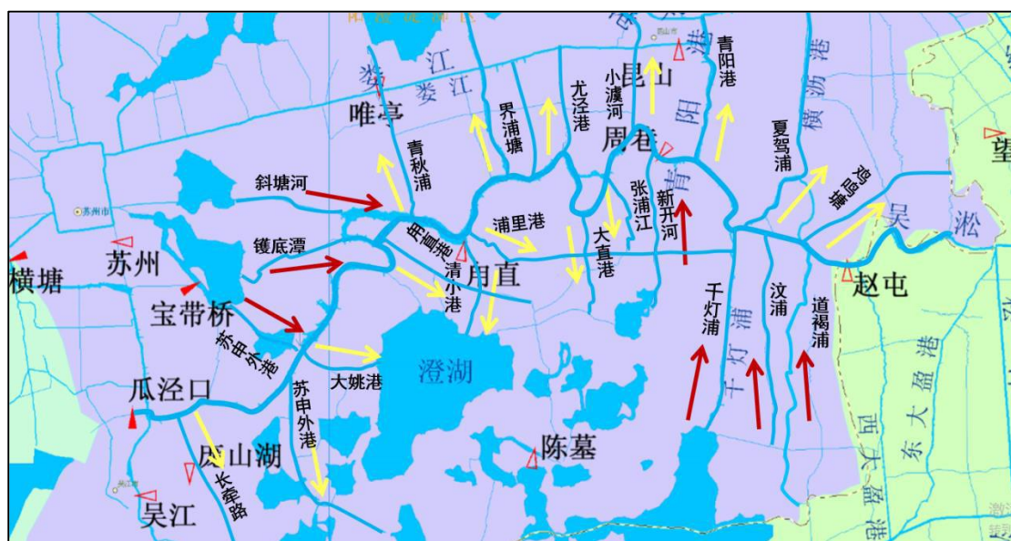
图 5.1-8 流域 100 一遇“99 南部”设计暴雨下两岸支流流向图
