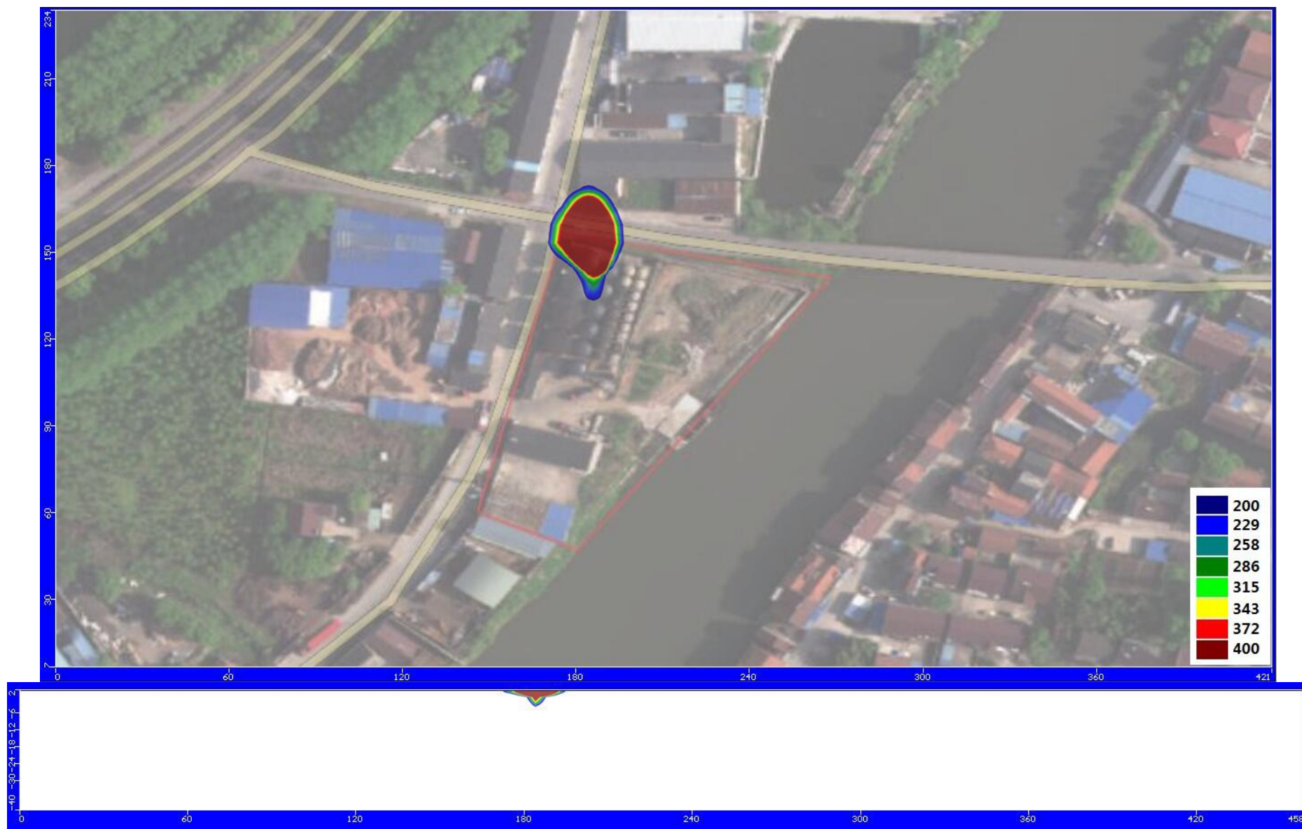
图6.3-9事故泄漏20a后钠浓度运移平面分布图
