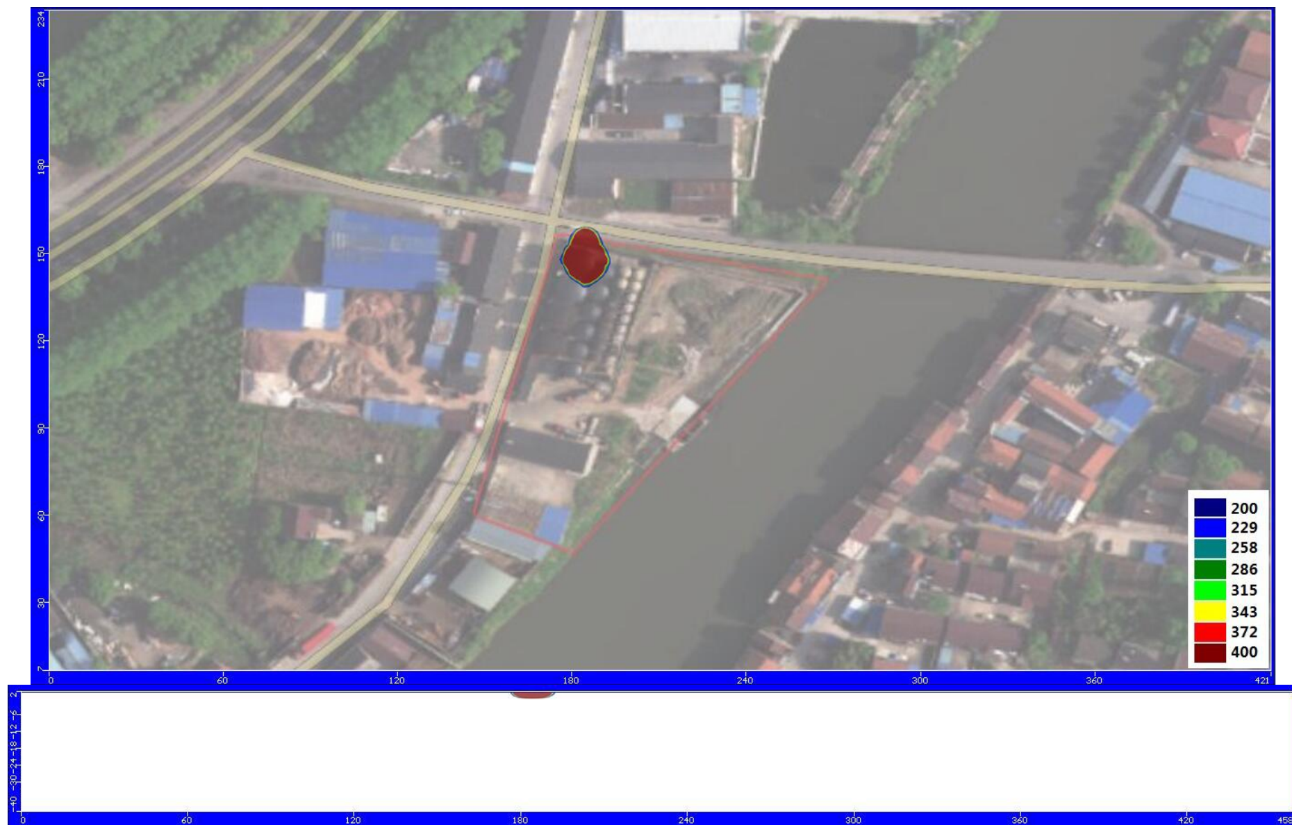
图6.3-7事故泄漏100天后钠浓度运移平面分布图
