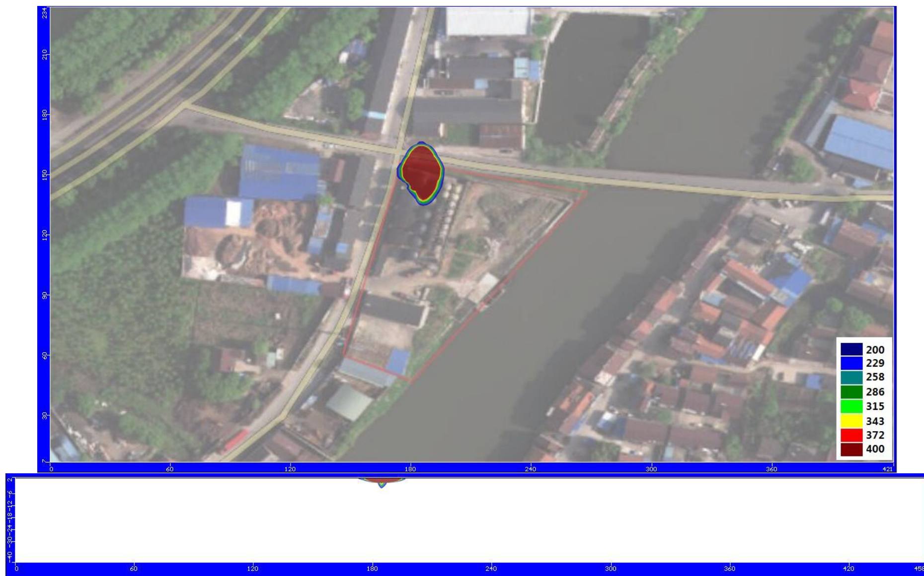
图6.3-8事故泄漏1000天后钠浓度运移平面分布图
