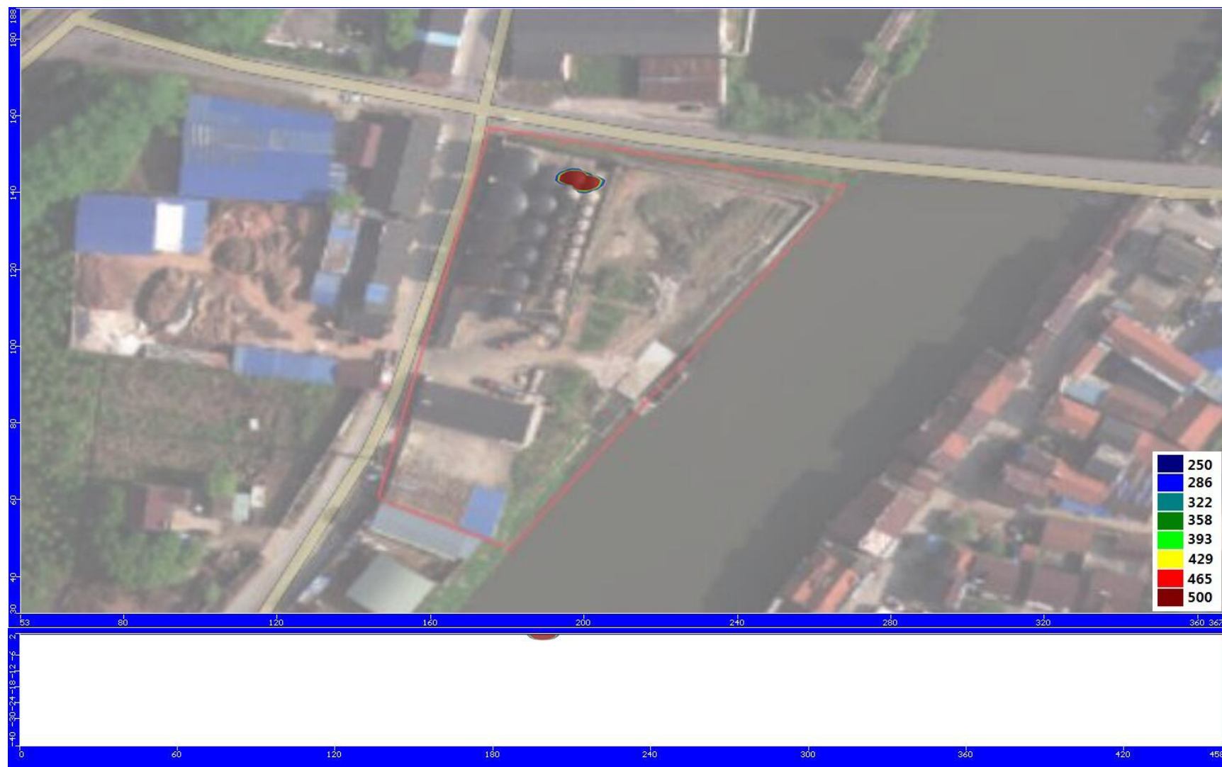
图6.3-4非正常泄漏100天后氯化物浓度运移平面分布图
