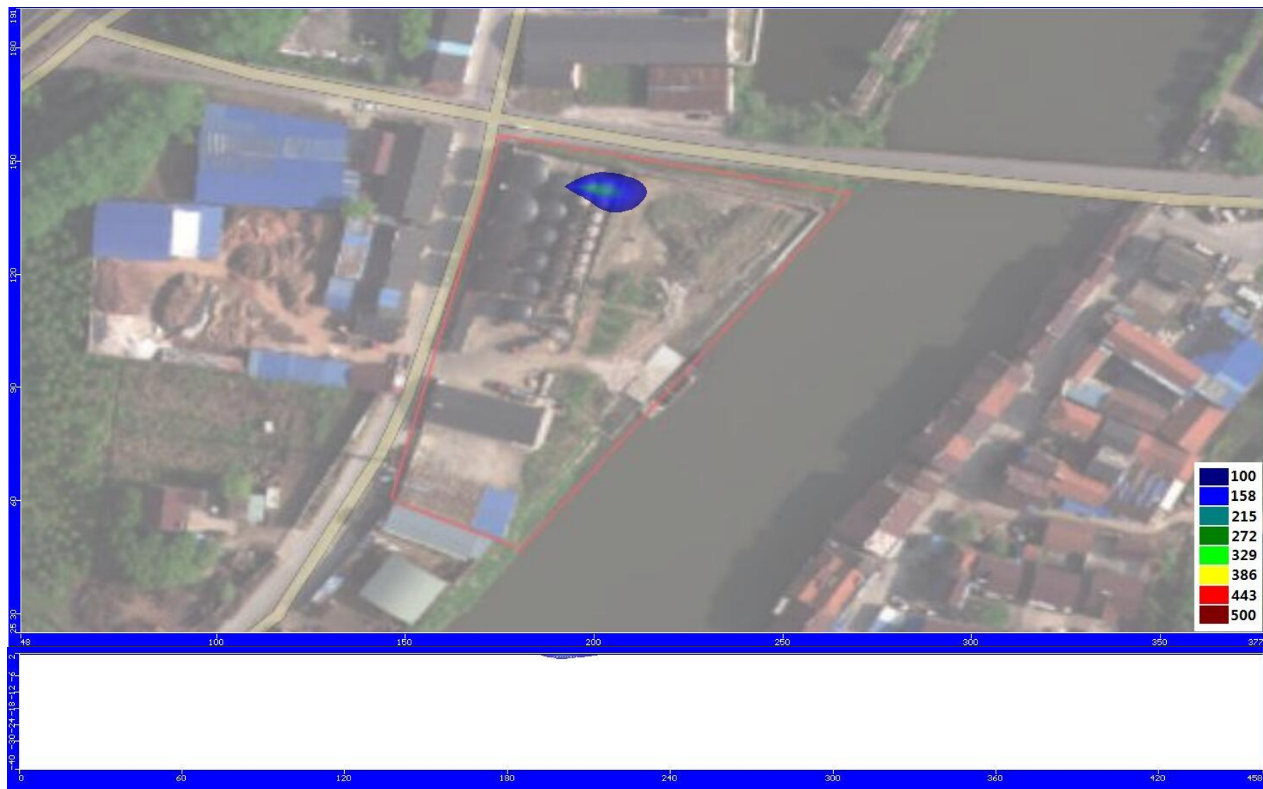
图6.3-6非正常泄漏20a后氯化物浓度运移平面分布图
