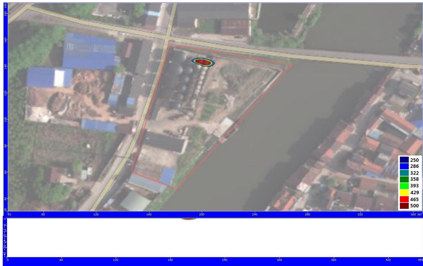
图6.3-5非正常泄漏1000天后氯化物浓度运移平面分布图
