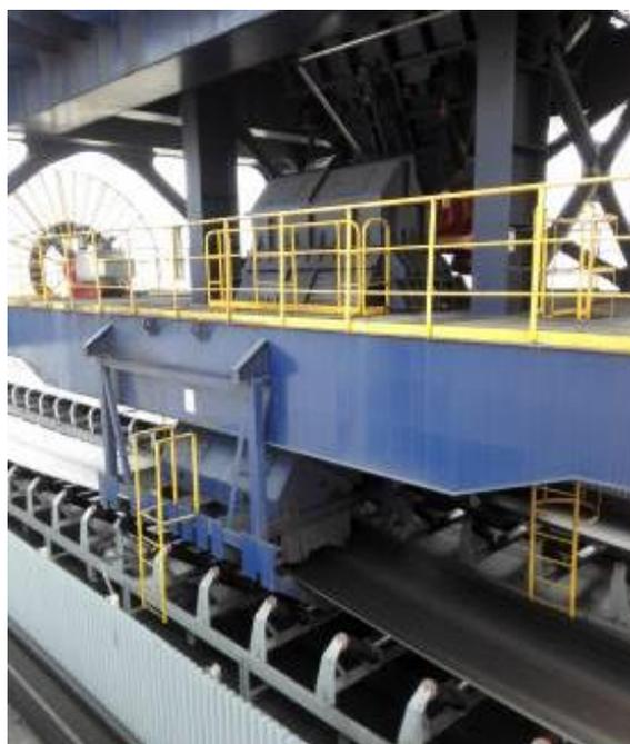
图 6.1-3 卸料漏斗下口防尘帘示例图
