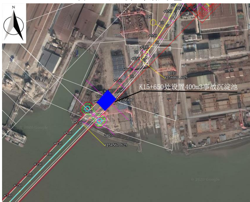
图 8-3-10 中汊桥北侧事故池位置
