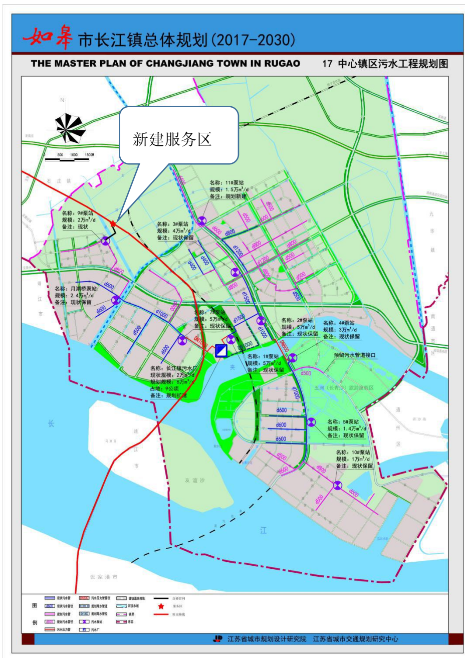
图 8-3-2 项目服务区与污水泵站位置关系
