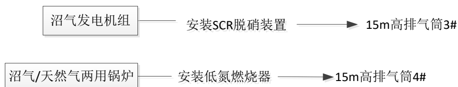
图 6.2-1 项目废气收集走向图
