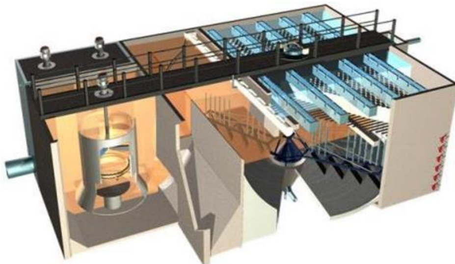
图 4.3-5 高效沉淀池结构示意图
