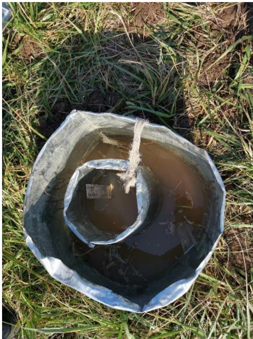
图 6.5-6 渗水试验现场照片
