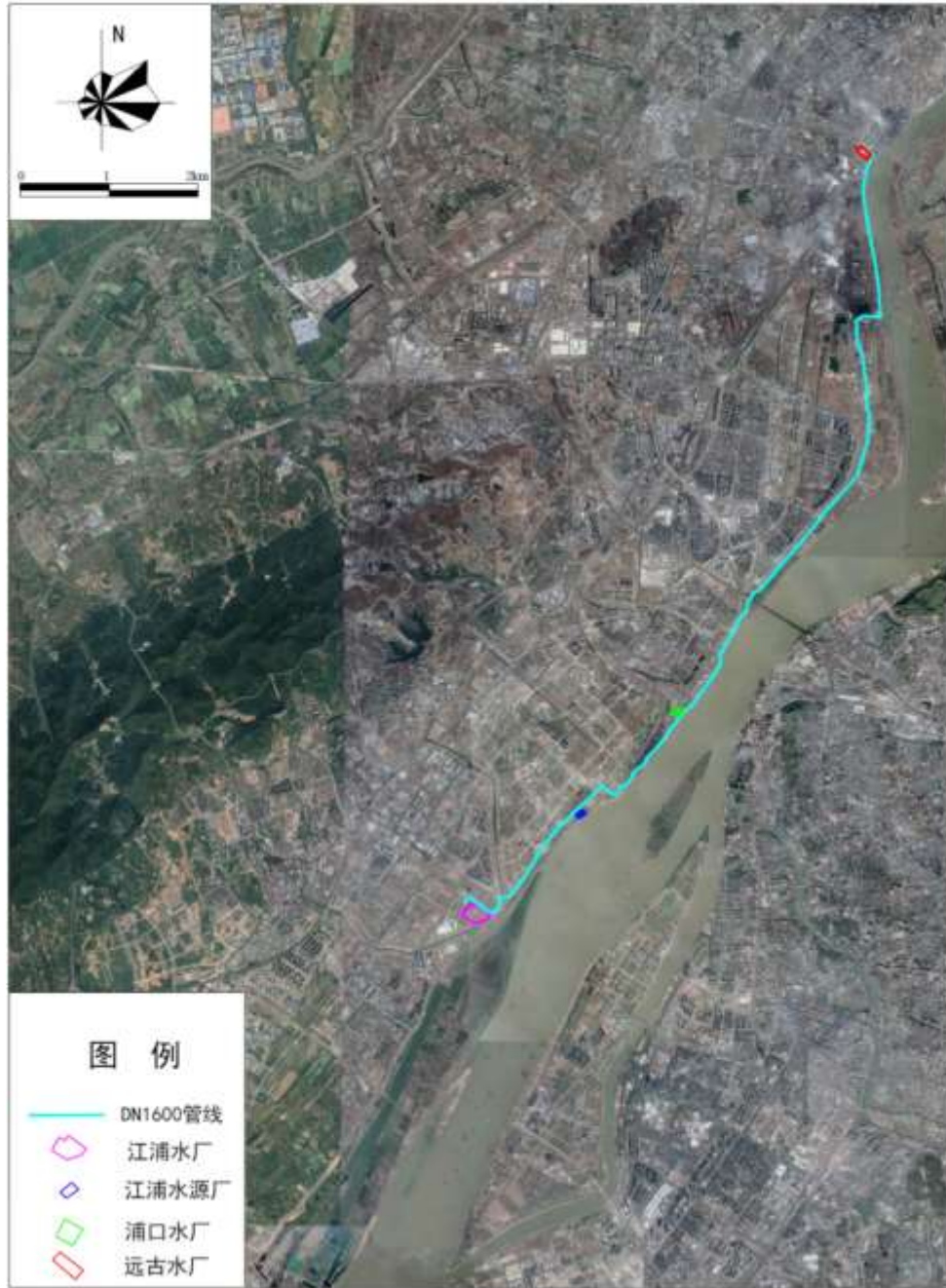
图3.2.3-8 江浦水厂至远古水厂清水管线路由图
