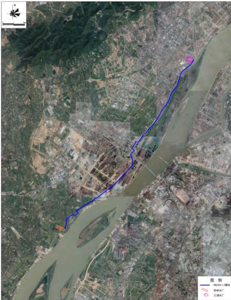
图3.2.3-6 桥林综合泵站至江浦水厂原水管线路由图
