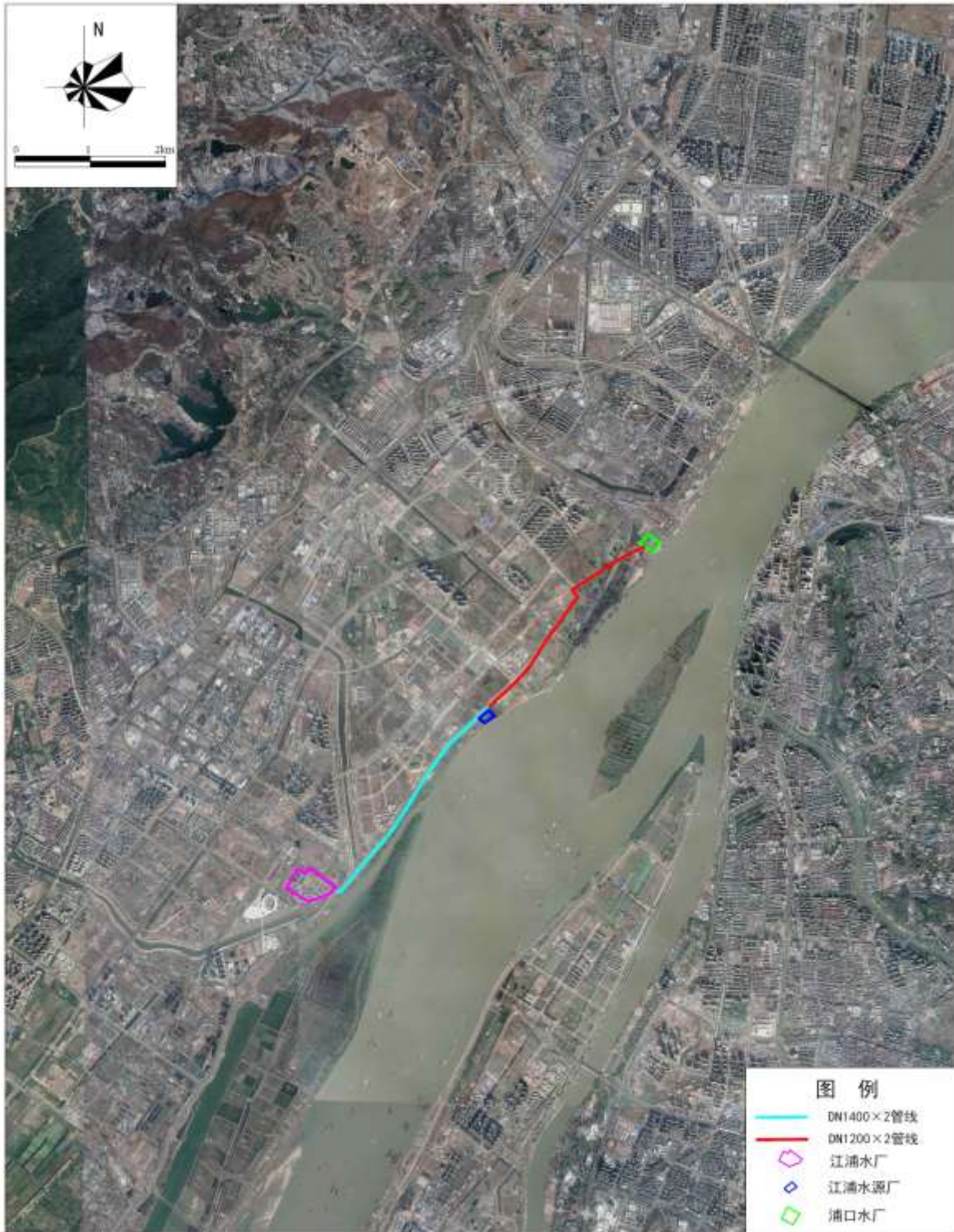
图3.2.3-7 江浦水厂至浦口水厂原水管线路由图（利用现有）
