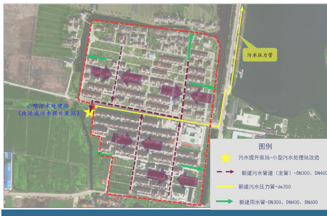
图 4.2-34 黎星小区新建雨污水系统平面图
