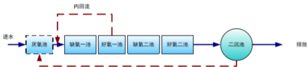
图 4.2-27 五段 Bardenpho 工艺
