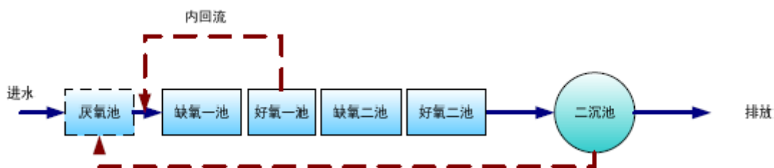
图 4.2-15 五段 Bardenpho 工艺
