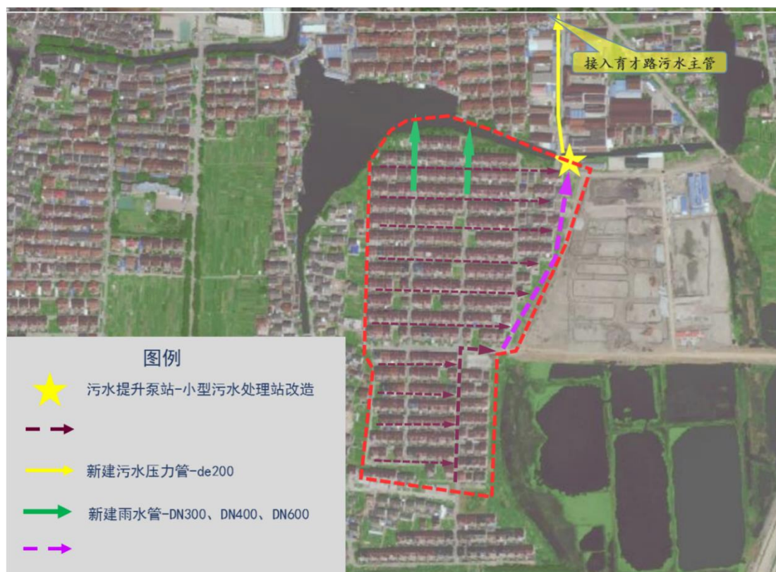
图 4.2-32 东村里小区新建雨污水系统平面图
