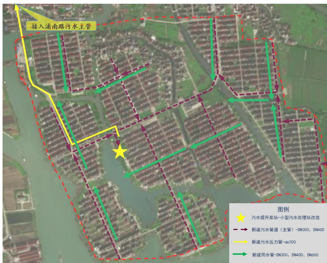
图 4.2-30 港南滨小区新建雨污水系统平面图
