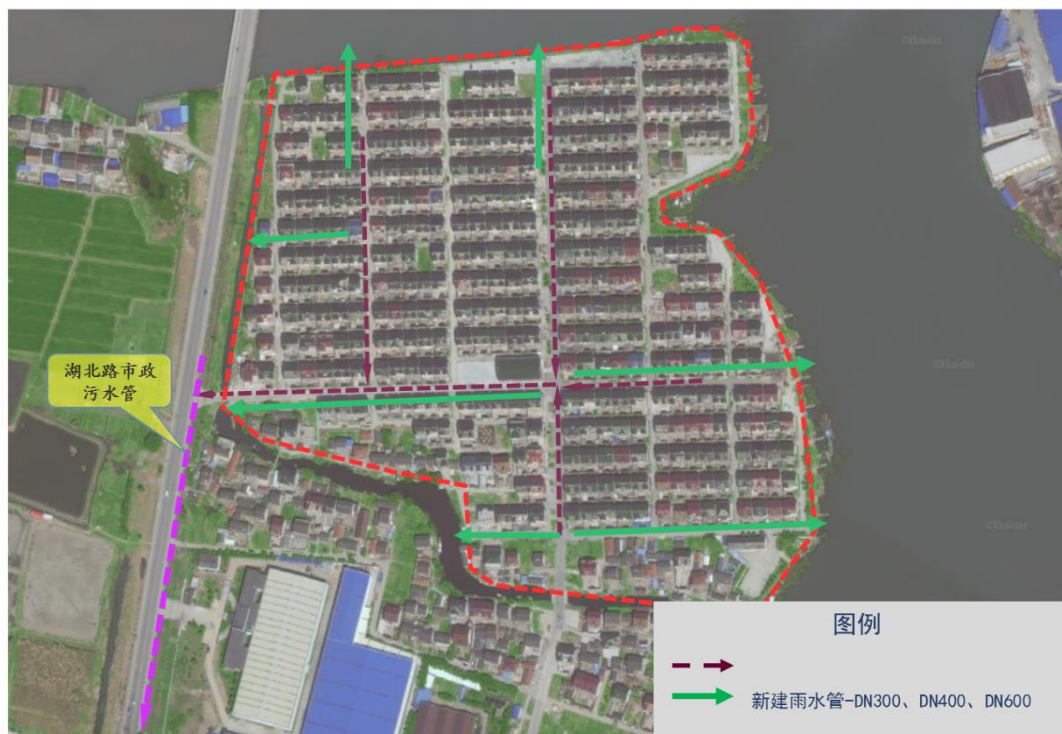
图 4.2-31 时基湾小区新建雨污水系统平面图
