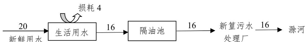
图6.2 建设项目水平衡图 （单位：t/a）
