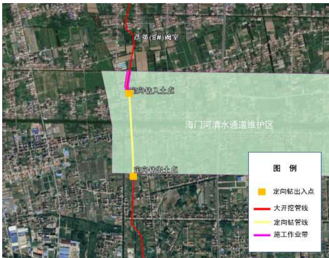
图7.7-1 管线路由与通吕运河（海门市）清水通道维护区的具体位置关系图
