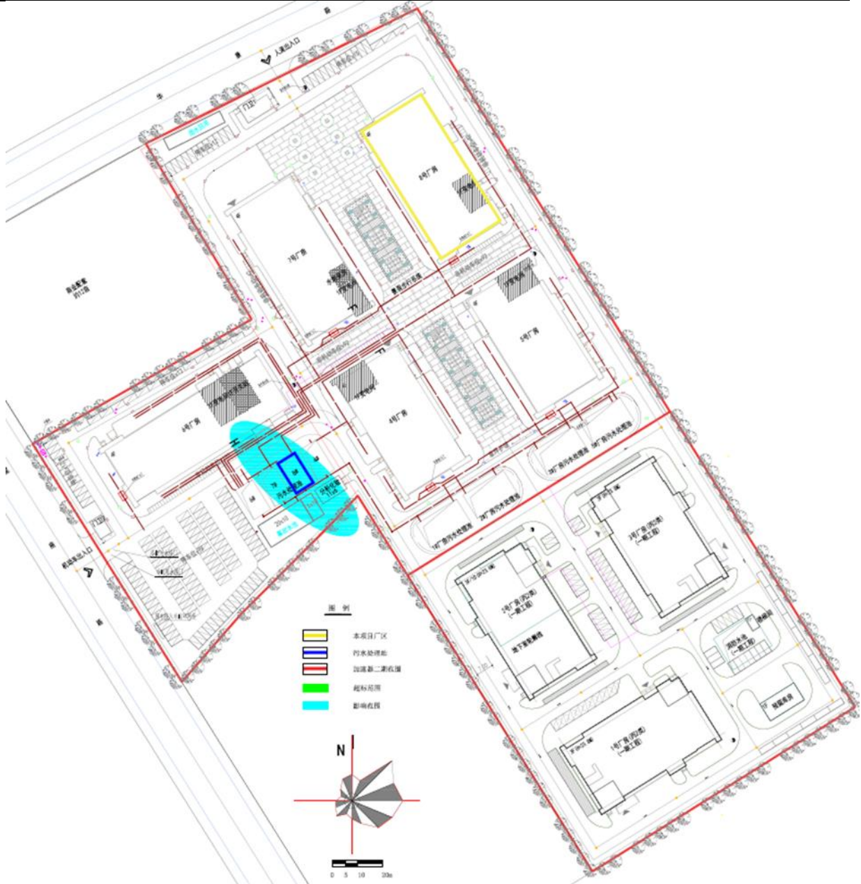
图 5.5.7-3b 废水收集池发生泄漏 1000 天 \text{COD}_{\text{Mn}} 的超标及影响范围
