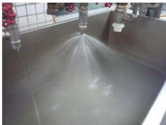
图 6.1-2 碱液喷淋洗涤塔及塔内喷雾装置示意图
