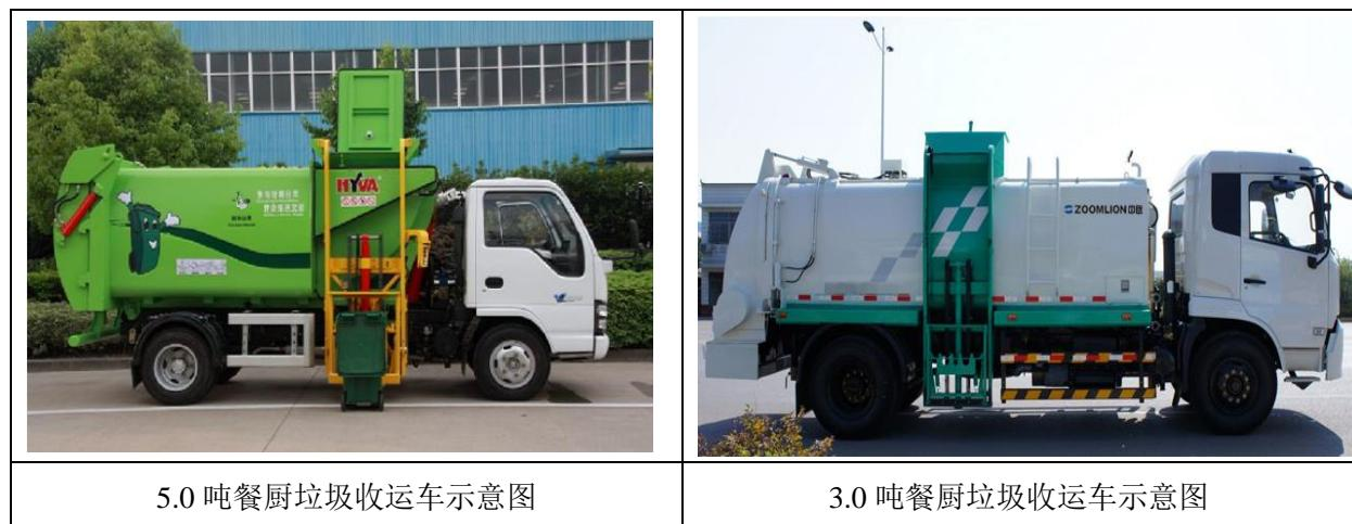
图 4.3-2 本项目拟采用的餐厨垃圾收运车示例图片
