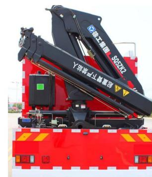
抢险救援消防车系选用德国曼商用车辆股份有限公司生产的 Arocs3345 型二类底盘改装而成，加长原驾驶室为双排座，可载含驾驶员在内的乘员 1+1+4 共 6 人，驾乘舒适轻便。在引进国外最先进的技术基础上，结合国内抢险特点进行创新开发设计，具有破拆、牵引、起吊、照明等诸多功能于一体，该车配有 10kW 发电机组和升降照明系统、前置 7 吨的牵引绞盘、后置 5 吨的折臂吊机。器材箱内可装配各种抢险救援器材 120 件。器材安装在升降拖架、立式抽拉、旋转拉架上。整车线型流畅、外观新颖、美观大方、器材布置合理紧凑、取拿方便。整车消防性能符合 GB7956 要求；底盘通过国家强制性产品认证；消防车排放符合国五标准。
