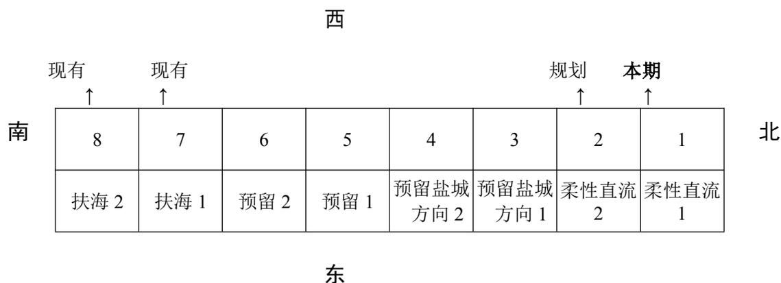
图 3.3 通海 500kV 变电站 500kV 出线间隔排列示意图
