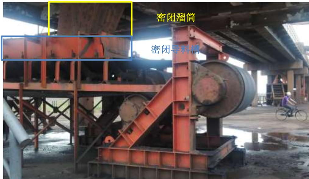
图 6.1-7 转运站下游皮带机密闭导料槽示例图
