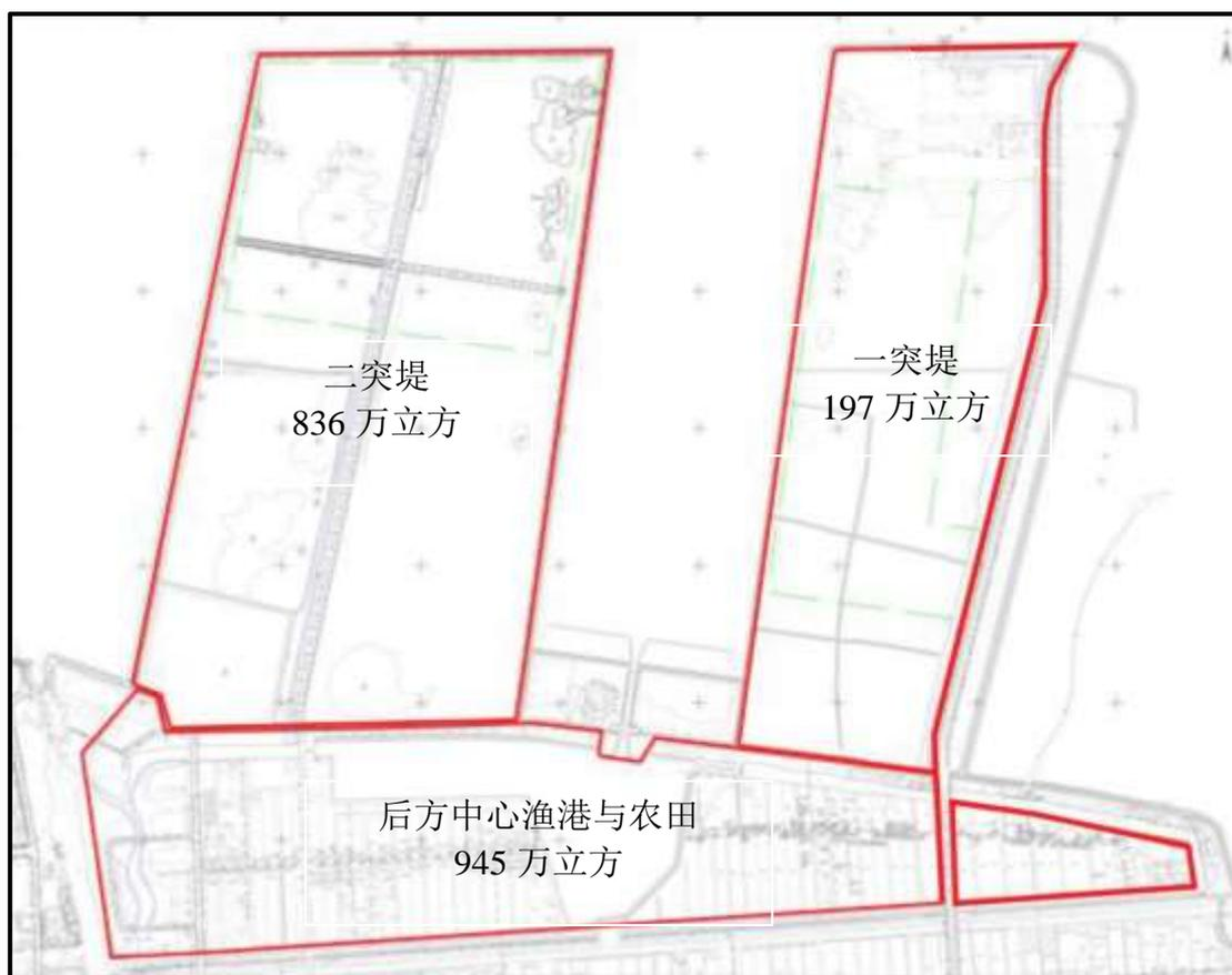
图 3.3-8 中天钢铁南通公司吹填土方需求分布图
