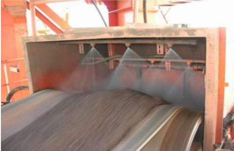
图 6.1-6 转运站上游皮带机头部密闭罩及喷雾装置示例图
