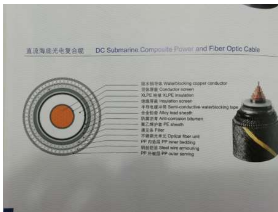
图 3.3-8 320kV 海底电缆剖面结构示意图
