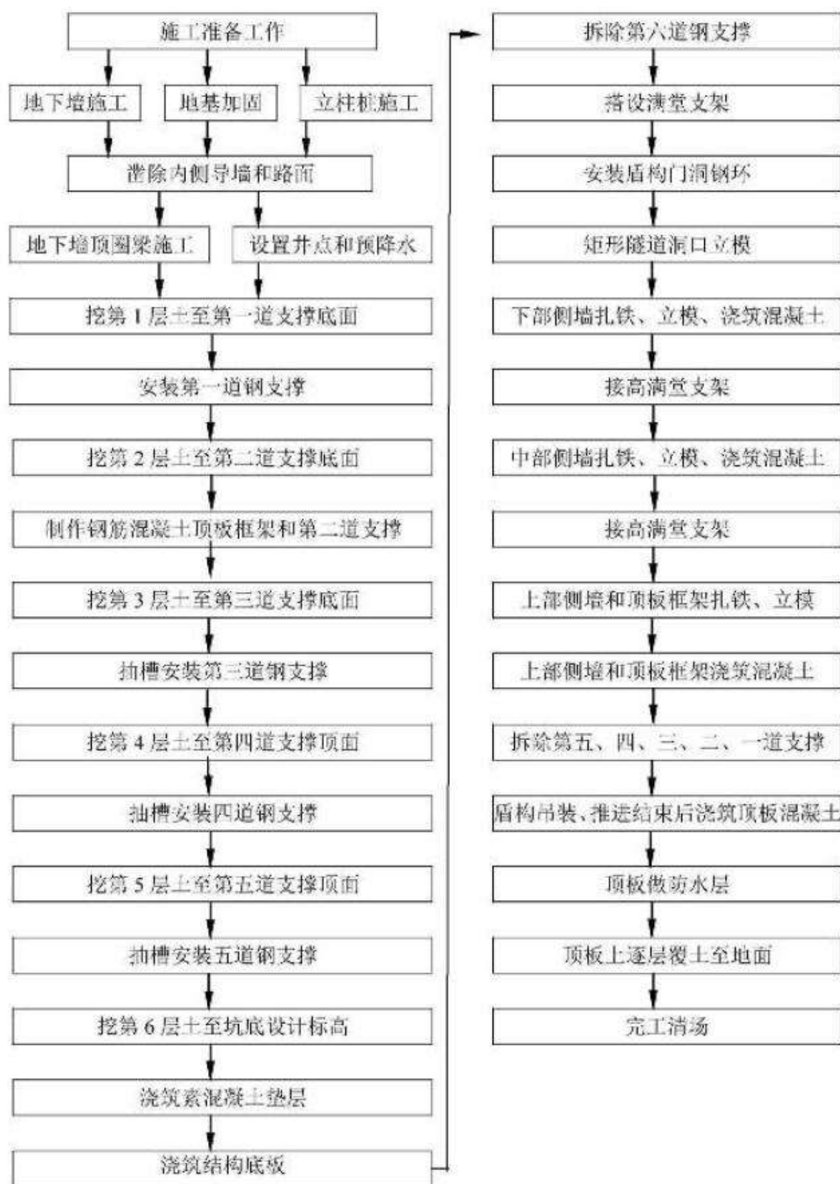
图 2-1-14 工作井施工流程示意图
