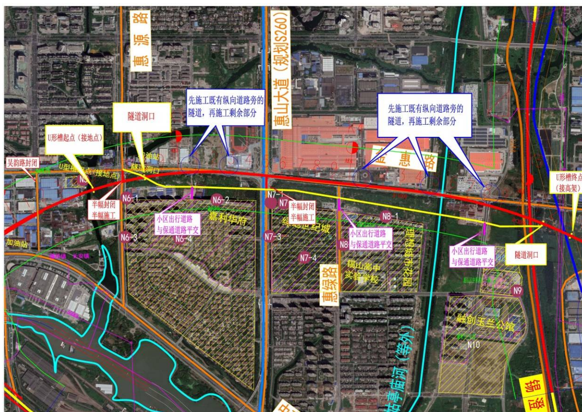
图 2.4-1 隧道段交通组织示意图
