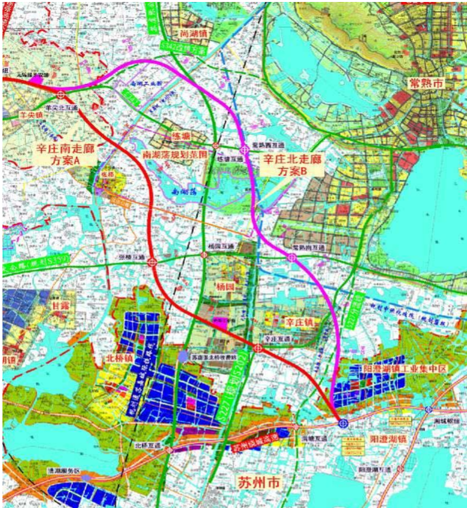
图 1.8-2 羊尖北-苏州绕城高速段比选方案布设示意图
