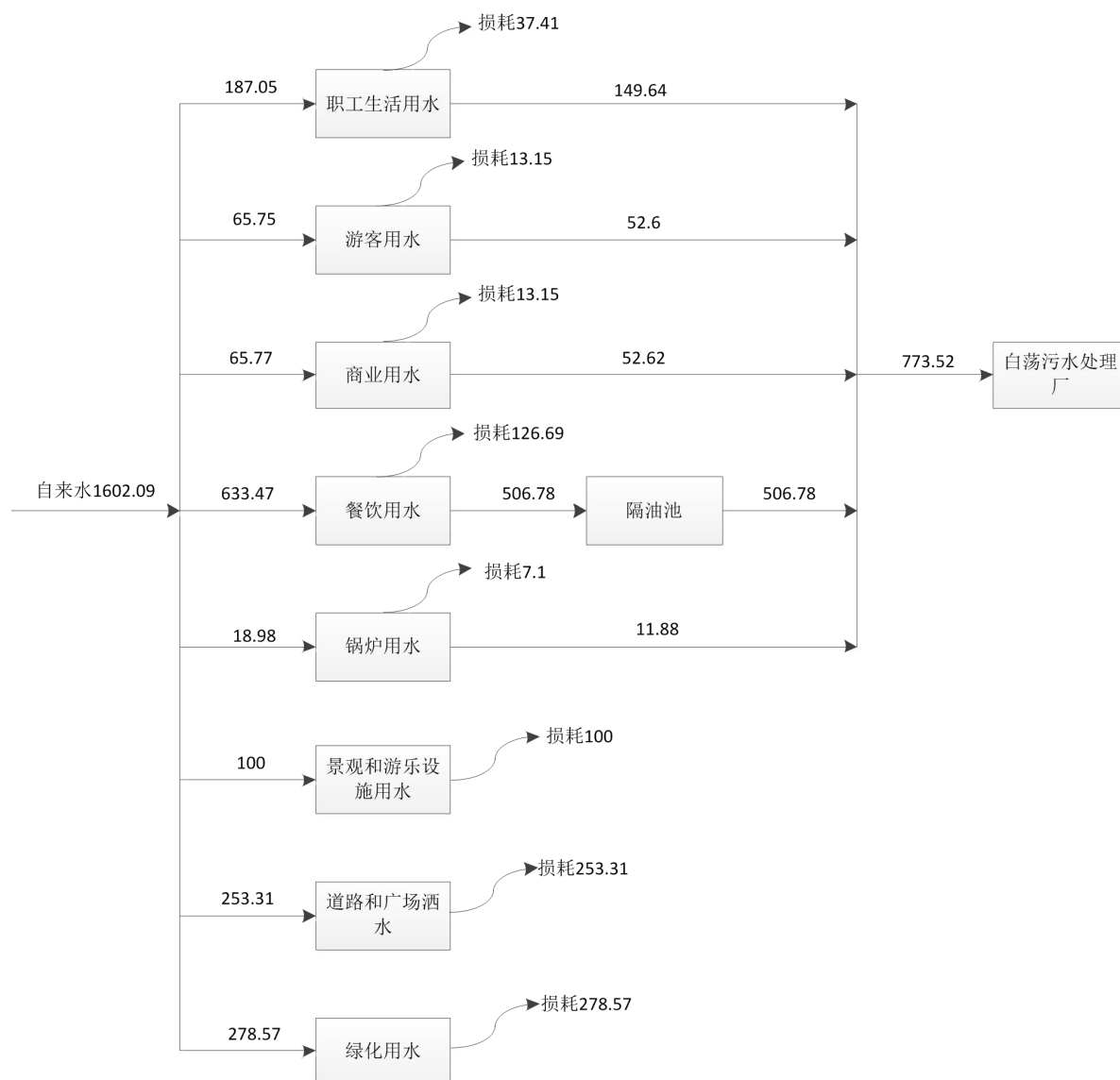
图 4.4-1 本项目园区水平衡图
