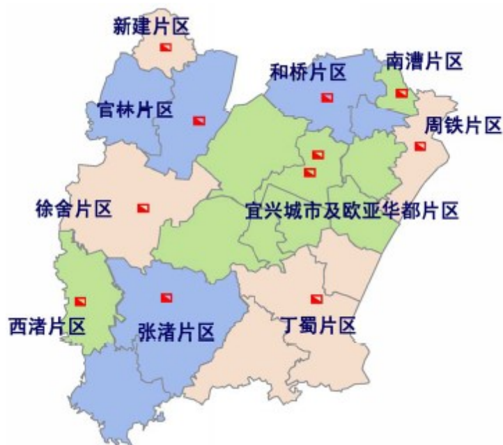
图 2.5-2 现状污水收集系统分区图
