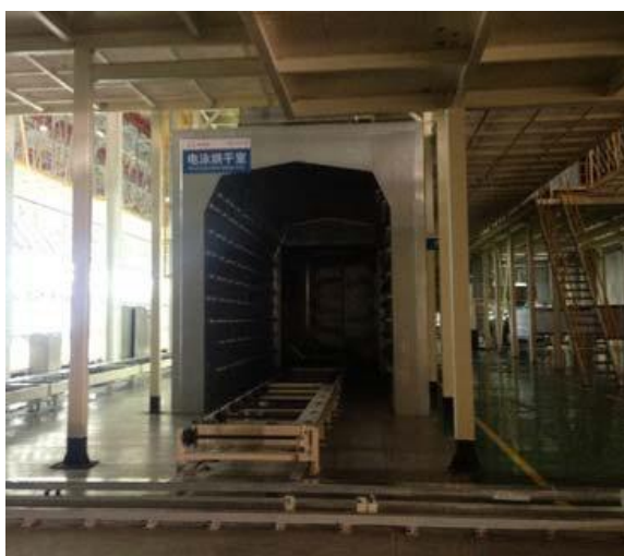
图 7.1-2 电泳烘干室示意图
