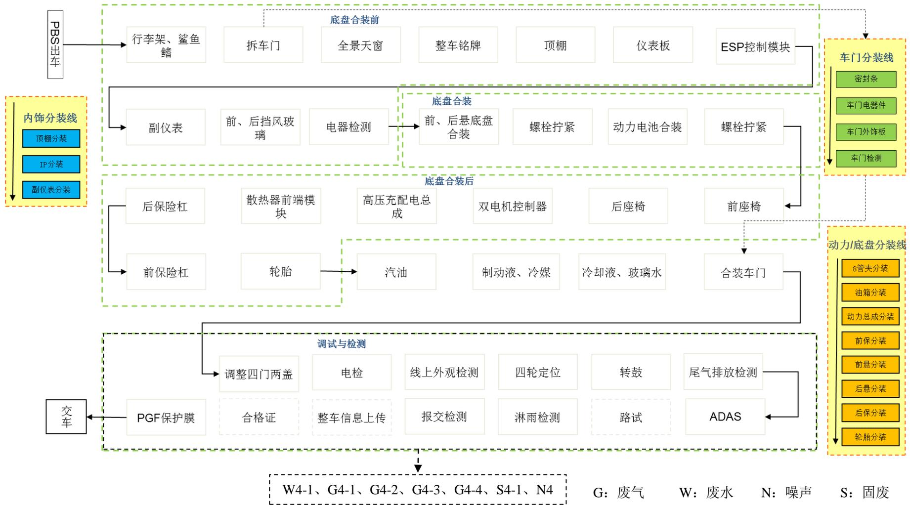
图 4.2-5 总装车间工艺流程图
