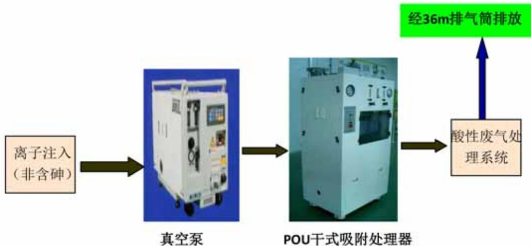
图 2.3-6 含砷干式吸附式工艺尾气处理流程示意图
