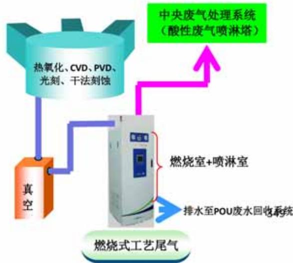
图 2.3-4 燃烧式工艺尾气处理流程示意图
