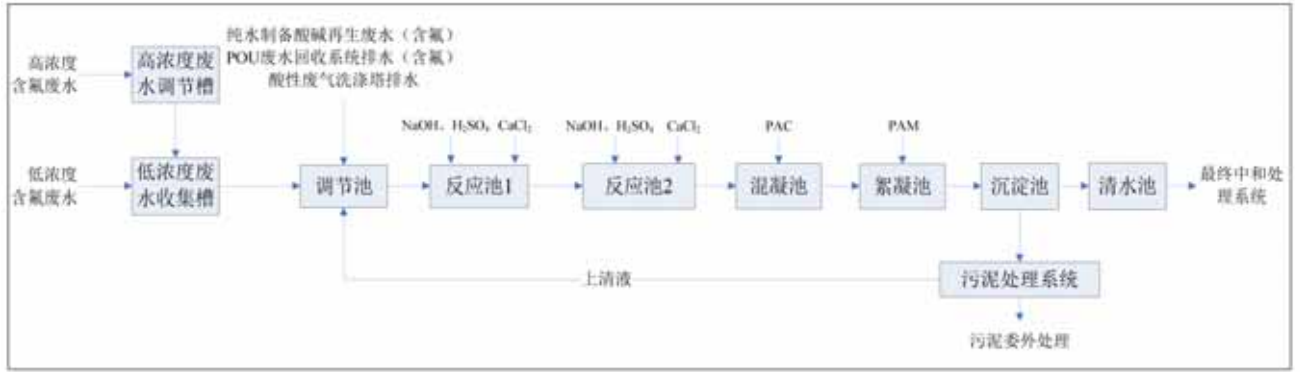
图 9.1-2 含氟废水处理系统工艺流程图
