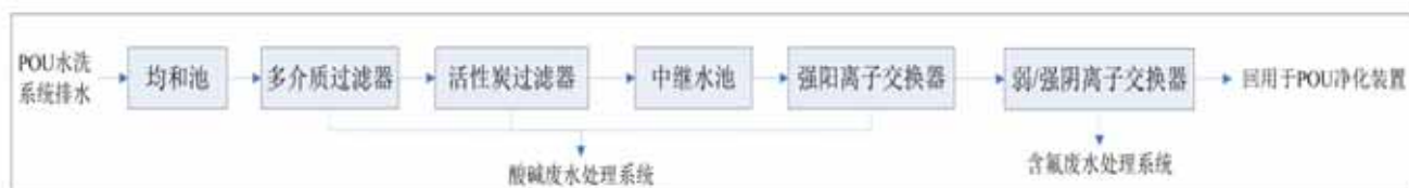
图 9.1-7 POU 废水回收处理流程图
