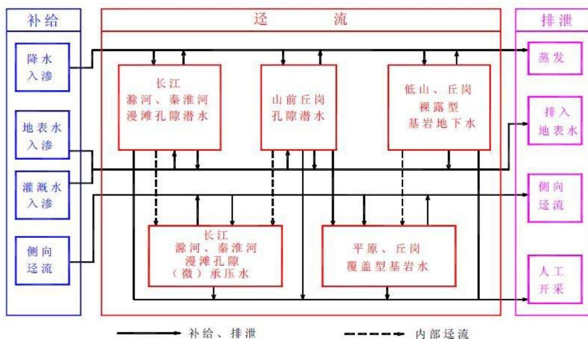
图8.2-2 地下水补给、径流、排泄关系略图
