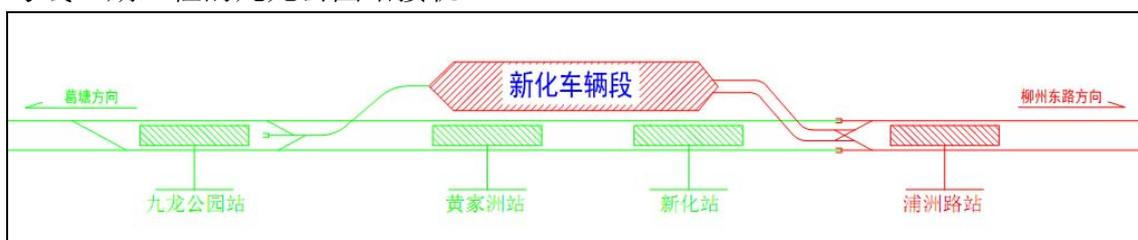
图 2.12-3 出入段线接轨方案示意图
