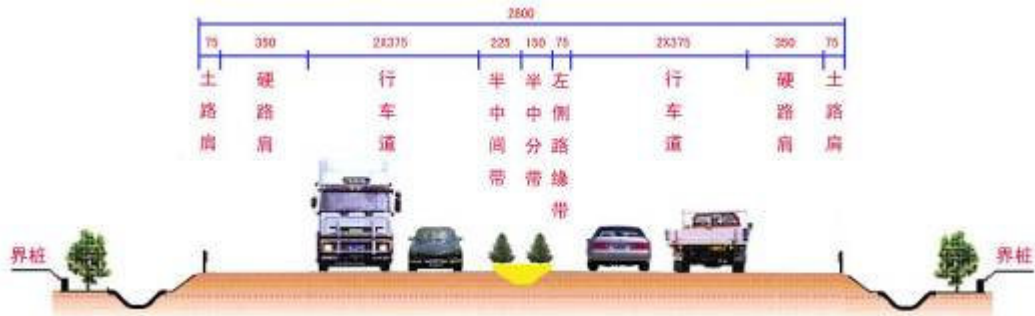
图 2.3-1 28m 路基横断面布置图
