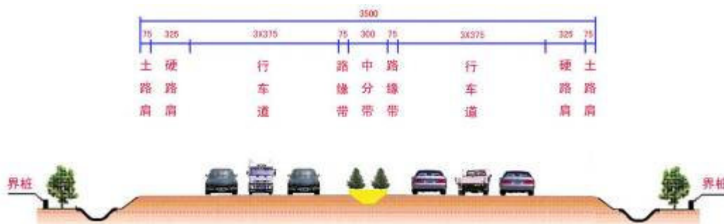
图 2.3-2 35m 路基横断面布置图
