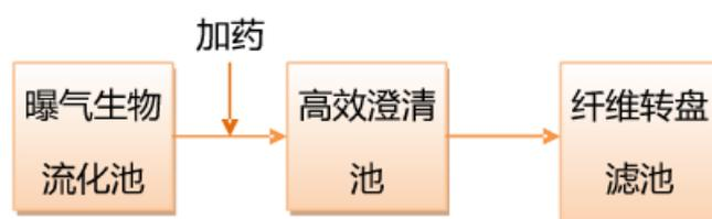
图7-1 珠江污水处理厂污水处理工艺流程图
