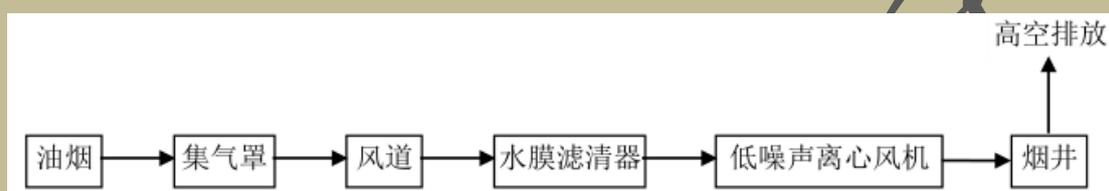
图 9.3-1 停车场和车辆段食堂油烟废气治理措施工艺流程图
