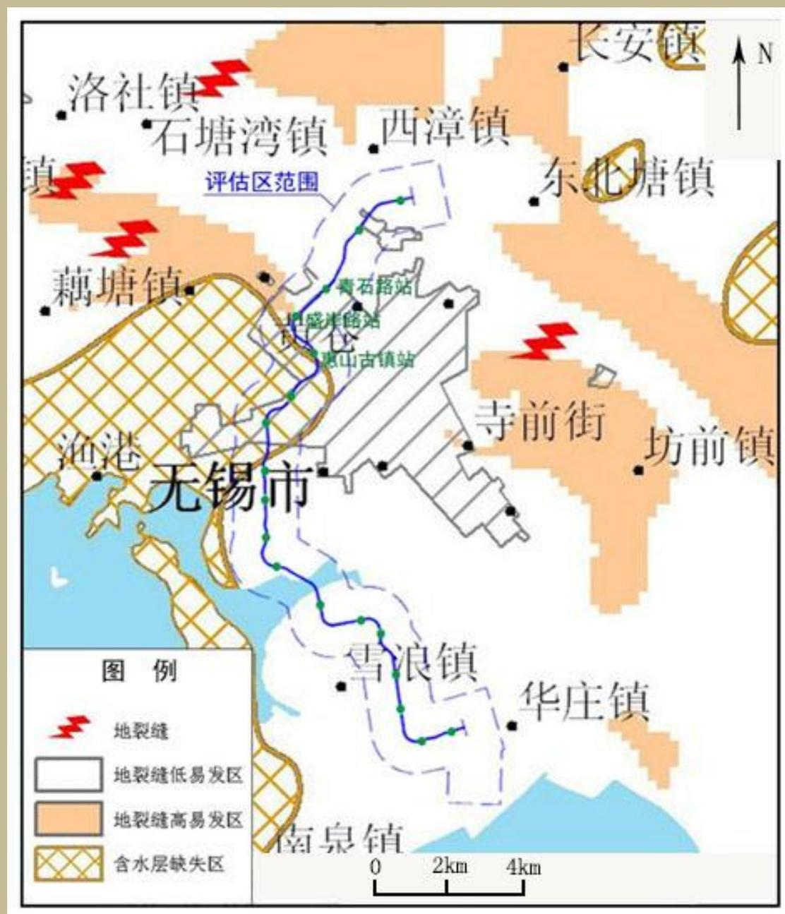
图 8.3-11 拟建工程及附近地裂缝点及易发区图
