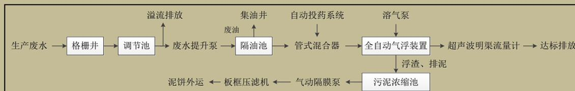
图 7.4-1 停车场和车辆段废水处理工艺流程图
