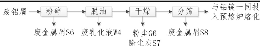
图1-3 原有项目铝屑回收工艺流程与产污环节图
