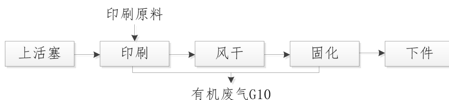
图 1-5 (3) 原有项目印刷工艺流程与产污环节图
