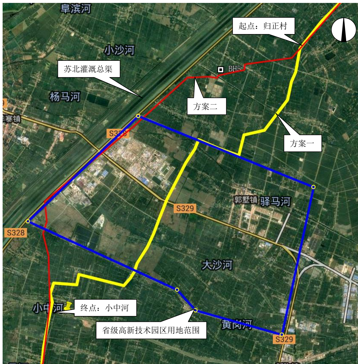
图 14.2-1 阜宁县省级高新技术园区段线路走向方案比选图
