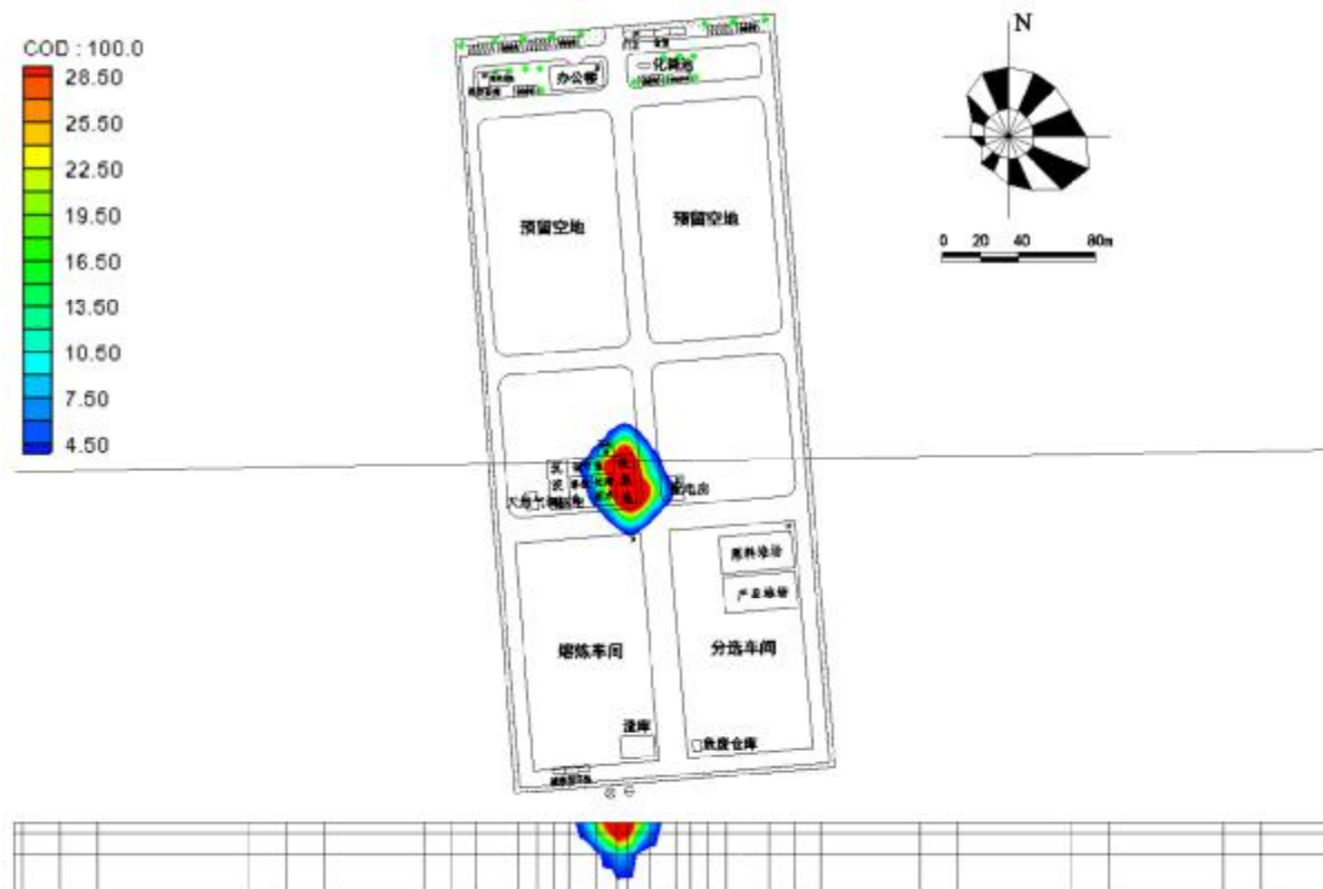
图 5.5-15 非正常工况下污水收集池 COD100d 运移图及剖面图
