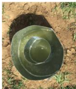
图 5.5-4 渗水试验现场照片
